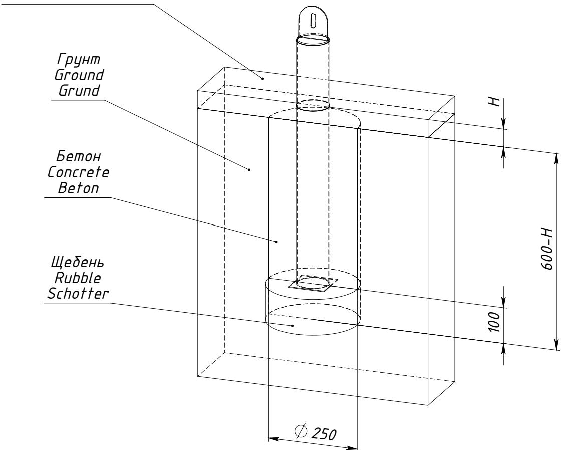
$H$  — толщина ударопоглощающего покрытия площадки
