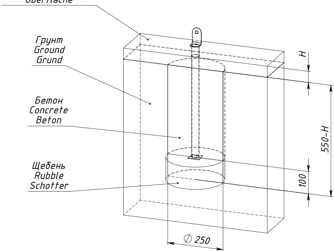
$H$  — толщина ударопоглощающего покрытия площадки
