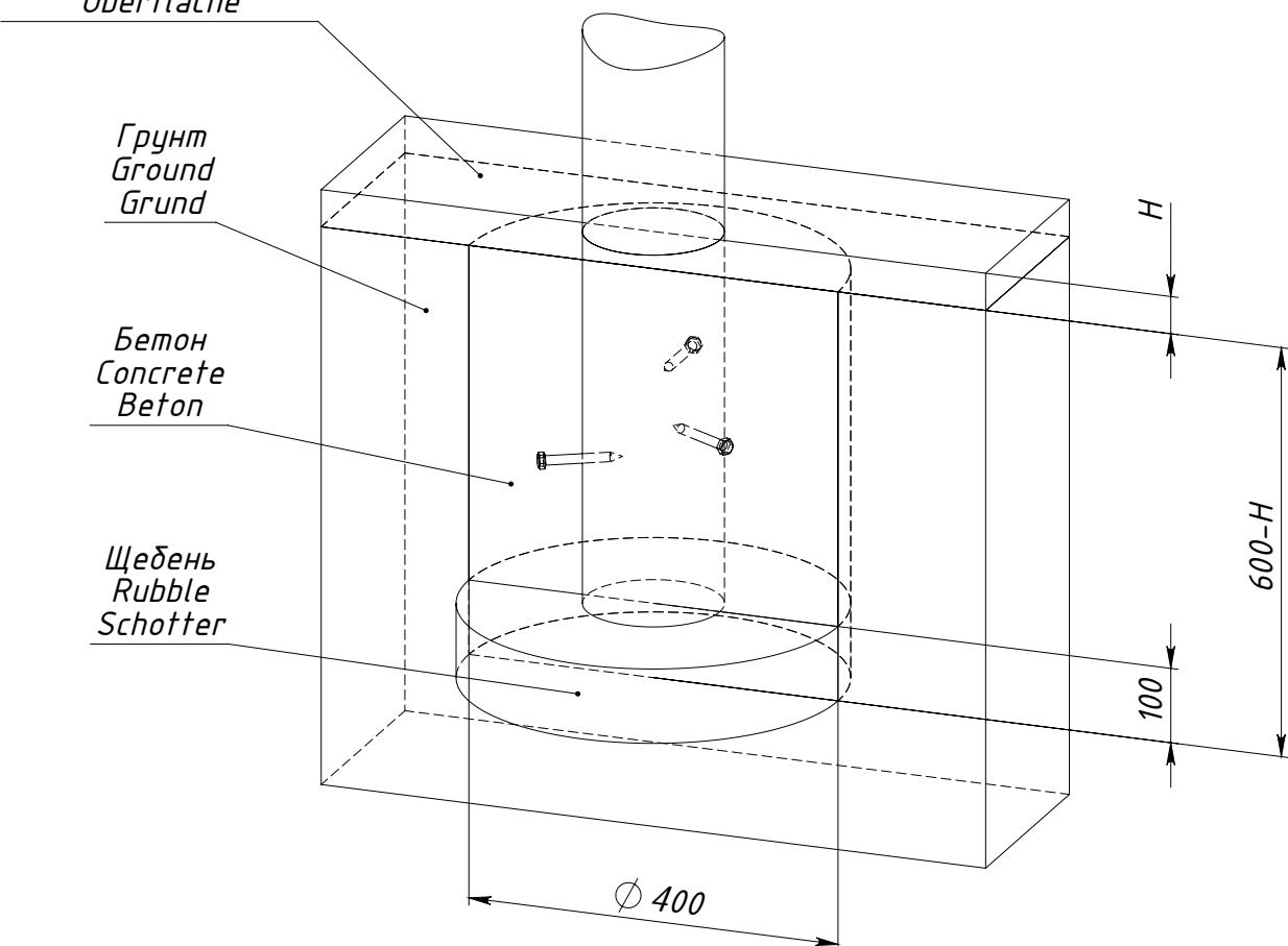
$H$  — толщина ударопоглощающего покрытия площадки
