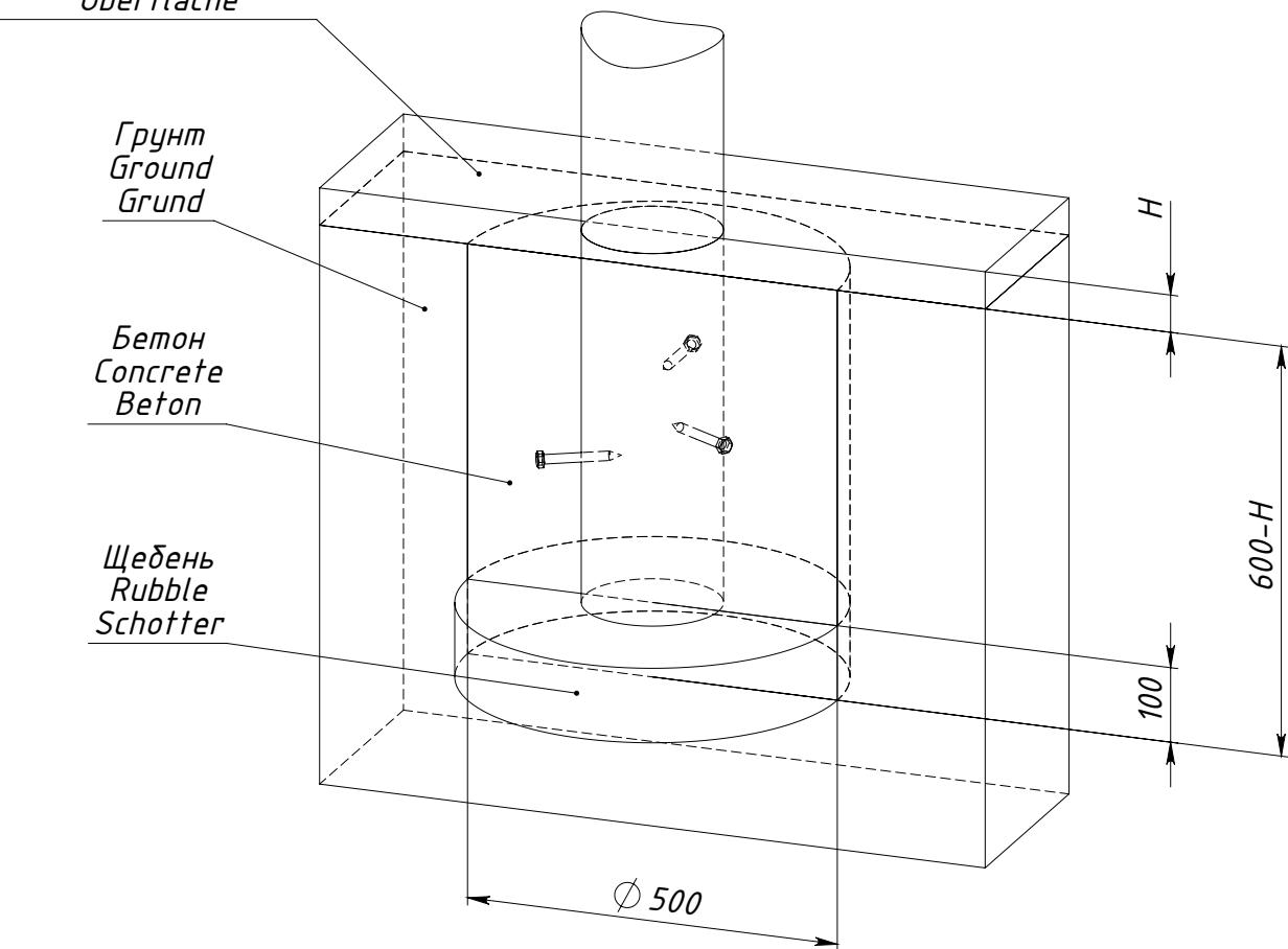
$H$  — толщина ударопоглощающего покрытия площадки
