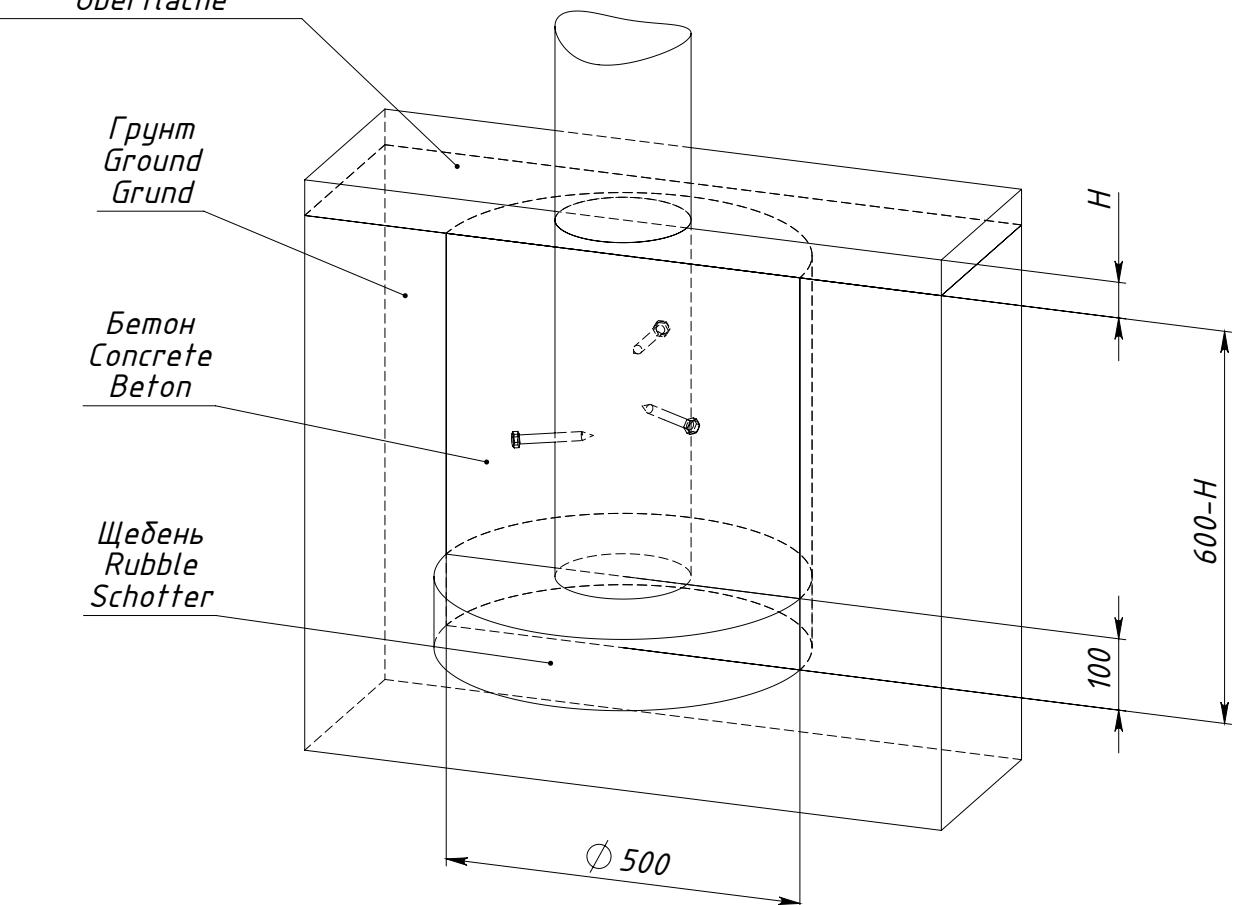
$H$  — толщина ударопоглощающего покрытия площадки
