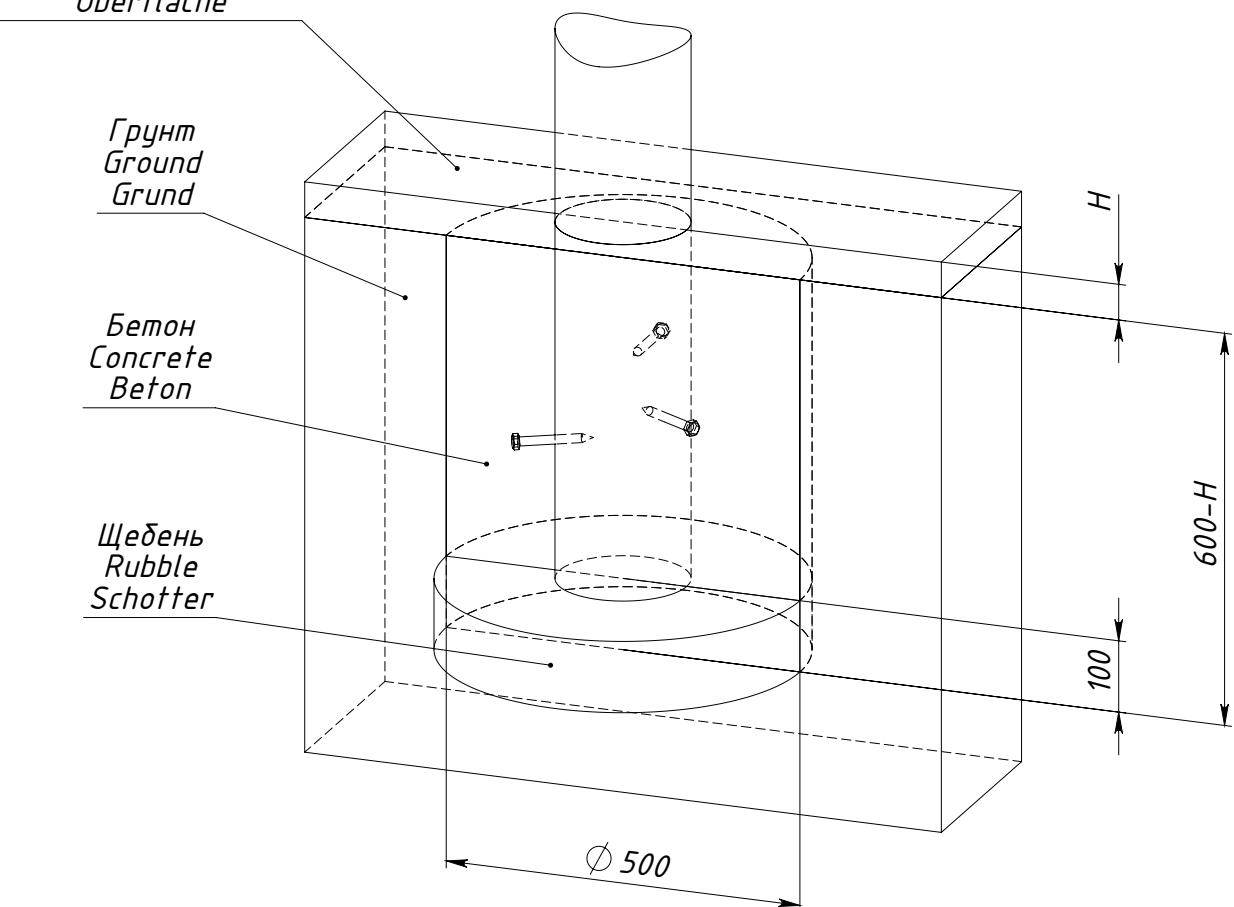
$H$  — толщина ударопоглощающего покрытия площадки
