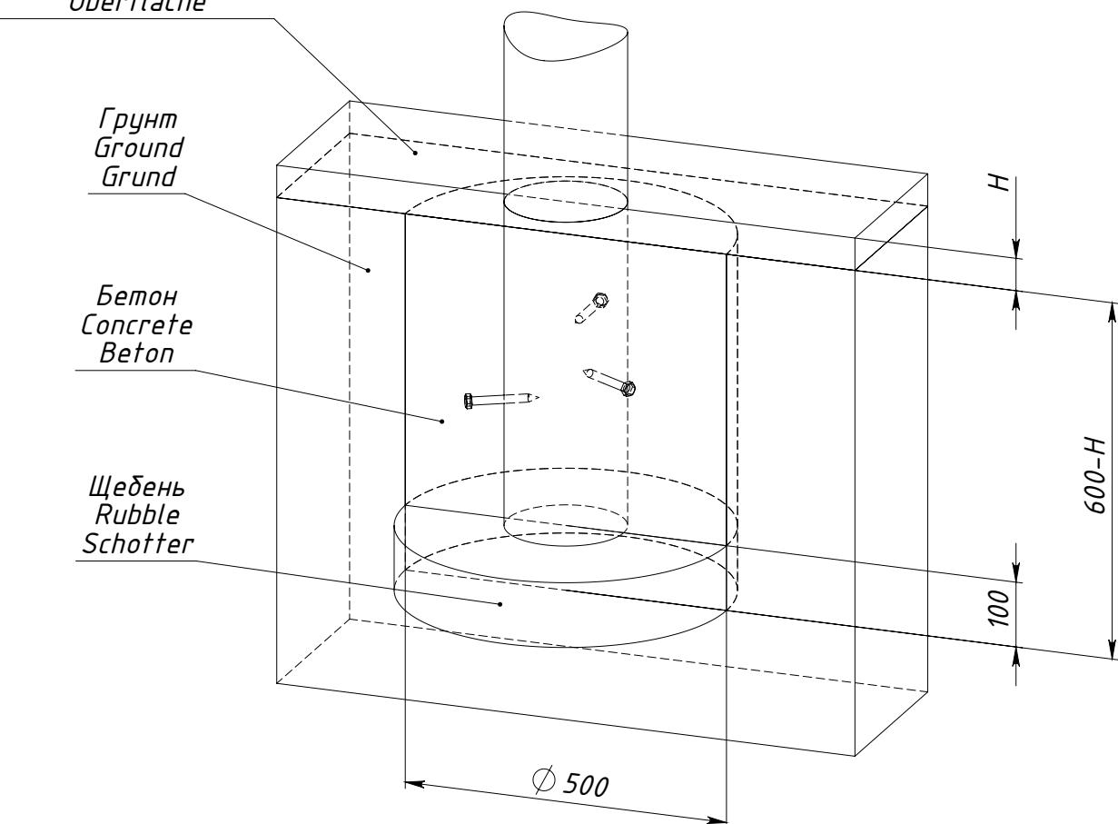
$H$  — толщина ударопоглощающего покрытия площадки
