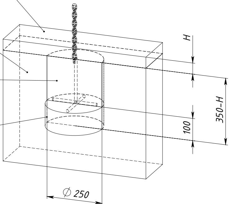
$H$  — толщина ударопоглощающего покрытия площадки
