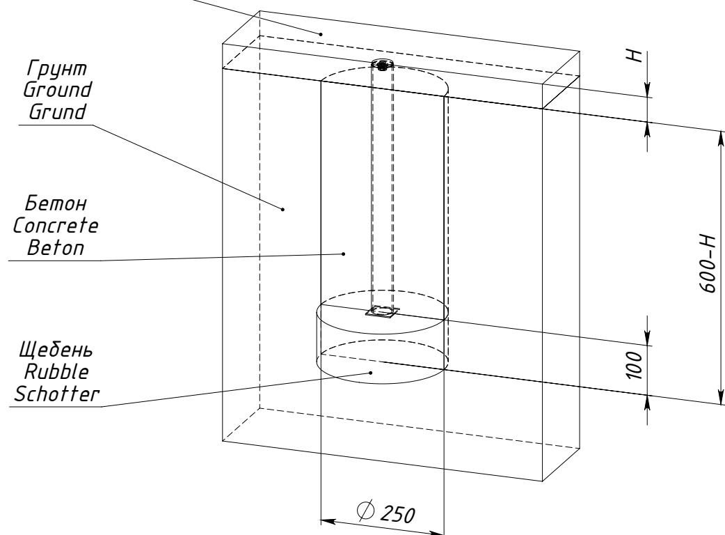
$H$  — толщина ударопоглощающего покрытия площадки
