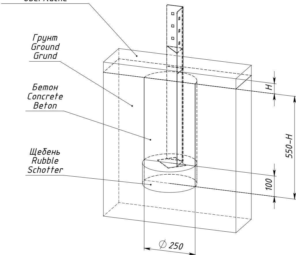
$H$  — толщина ударопоглощающего покрытия площадки
