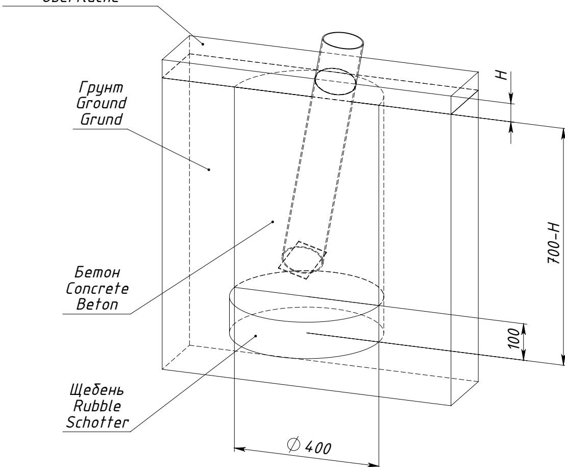
$H$  — толщина ударопоглощающего покрытия площадки
