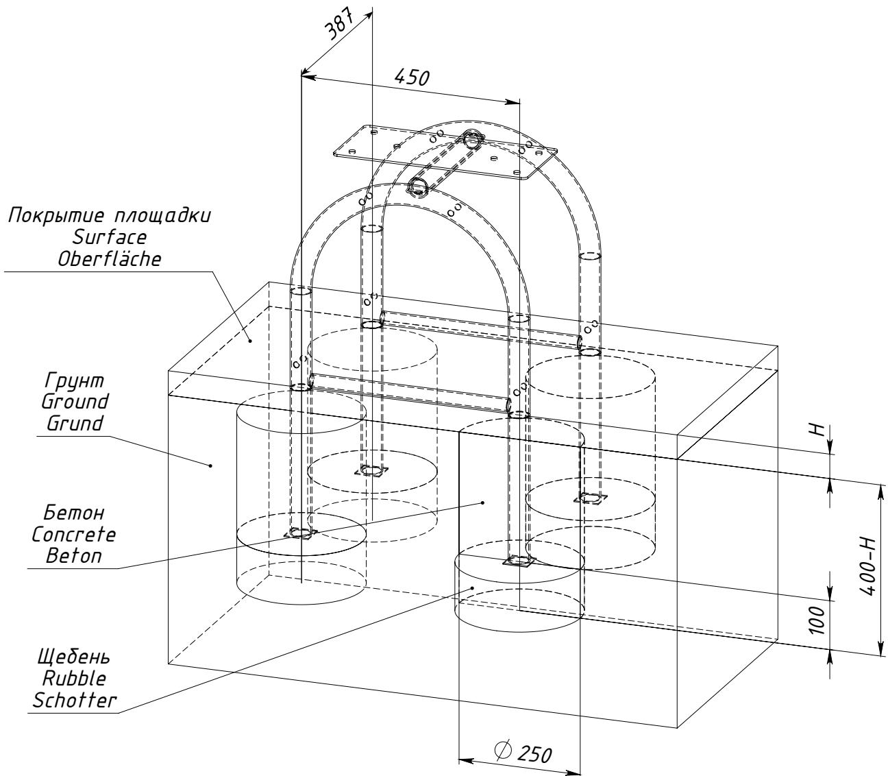
$H$  — толщина ударопоглощающего покрытия площадки
