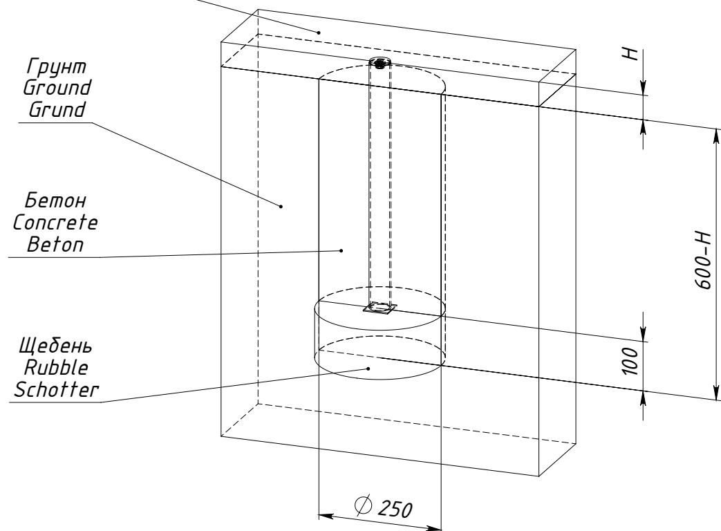
$H$  — толщина ударопоглощающего покрытия площадки
