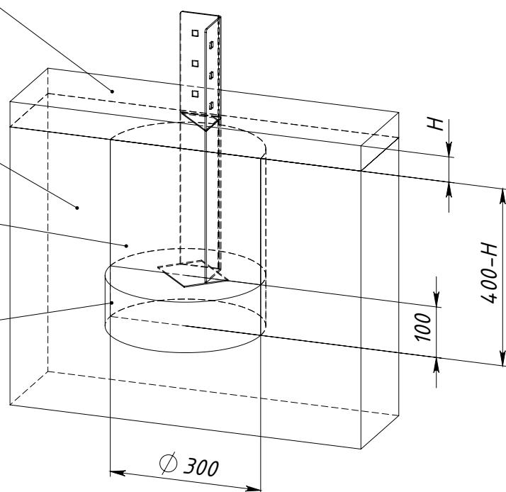
$H$  — толщина ударопоглощающего покрытия площадки
