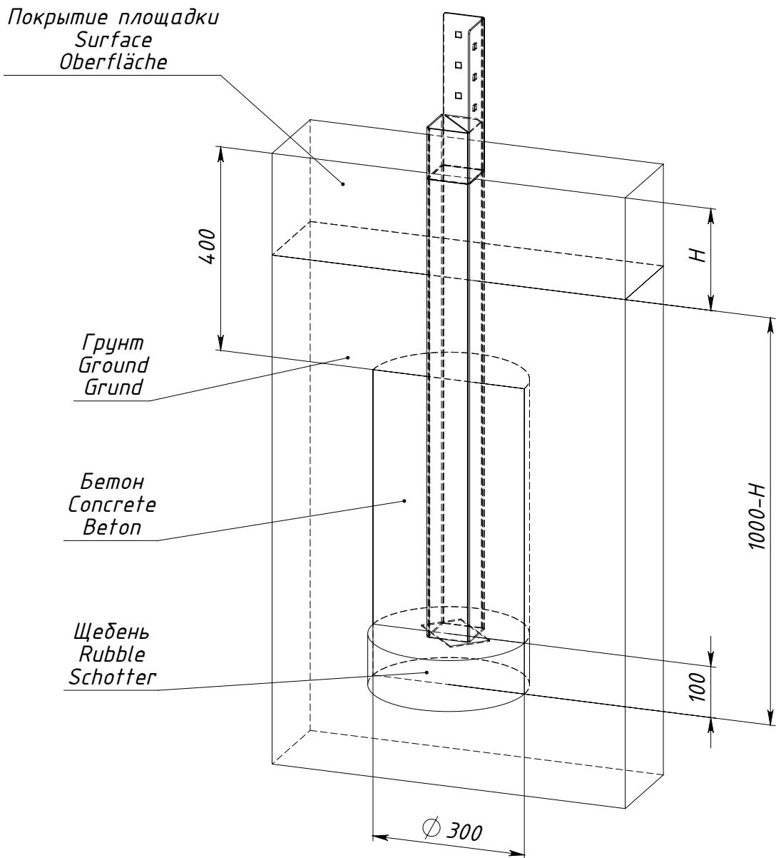
$H$  — толщина ударопоглощающего покрытия площадки
