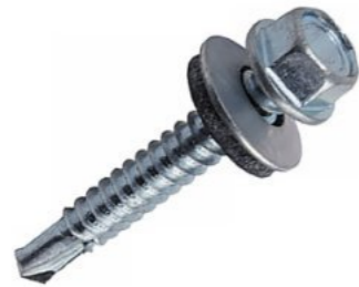
SH5`5.032.D7504K (Винт самонар. с буром, шайбой EPDM, 5,5×32, DIN 7504K) — 92 шт
