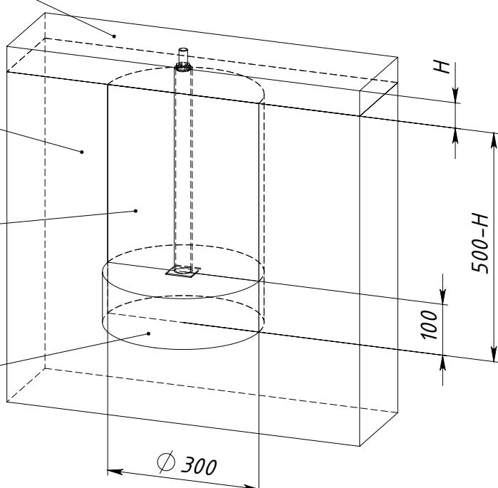
*H — толщина ударопоглощающего покрытия площадки*
