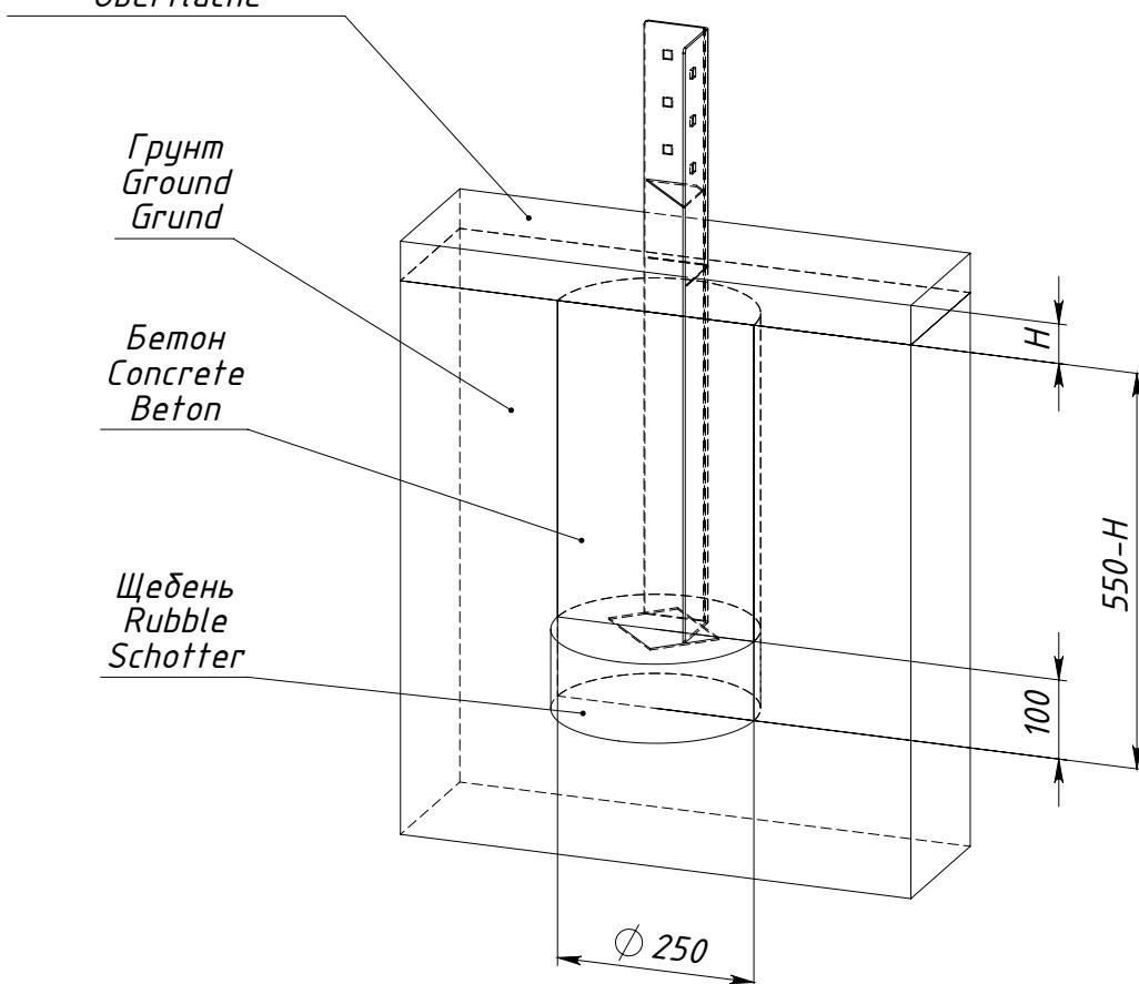
$H$  — толщина ударопоглощающего покрытия площадки
