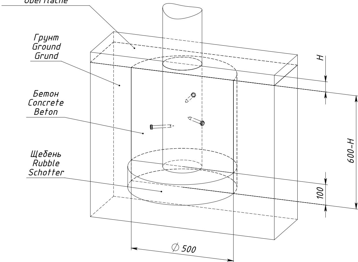
$H$  — толщина ударопоглощающего покрытия площадки
