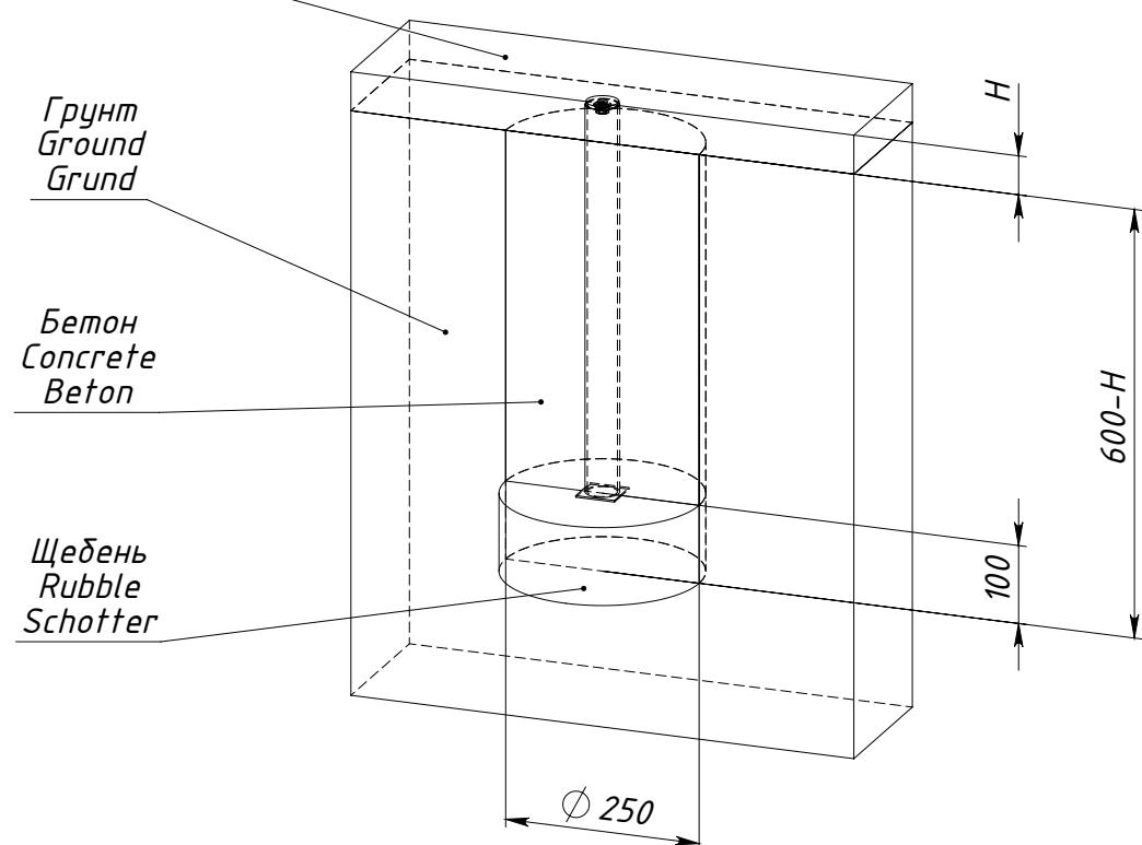
$H$  — толщина ударопоглощающего покрытия площадки
