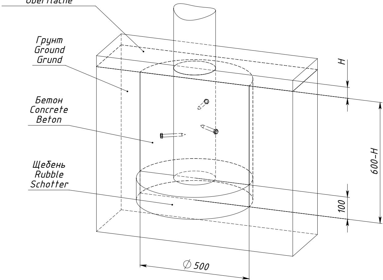
$H$  — толщина ударопоглощающего покрытия площадки
