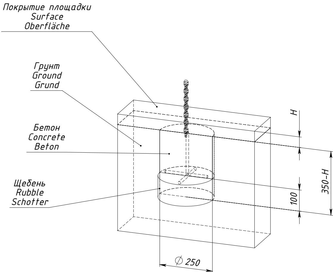
$H$  — толщина ударопоглощающего покрытия площадки
