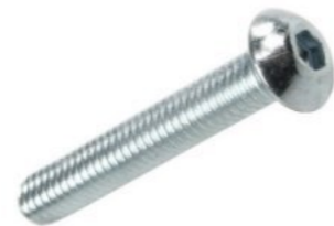
BO10.020.D7380 (Болт полусфер., с внутр. шестигр., М10×20, DIN 7380) — 6 шт
