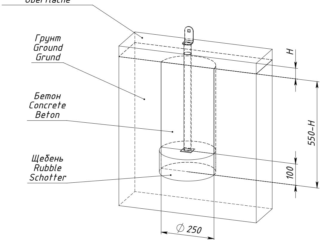
$H$  — толщина ударопоглощающего покрытия площадки
