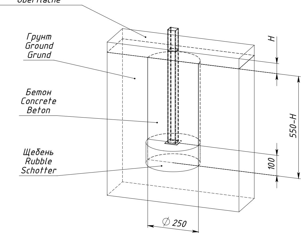
$H$  — толщина ударопоглощающего покрытия площадки
