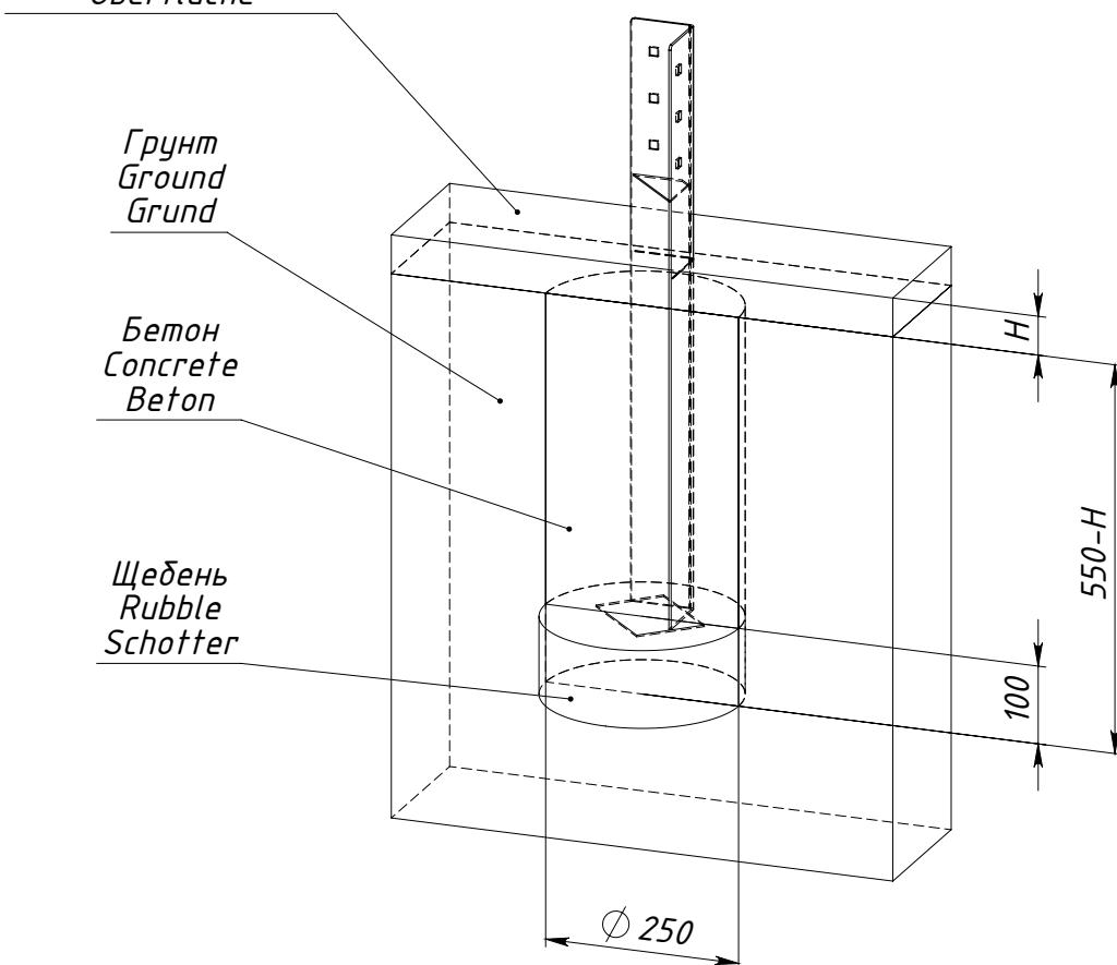
$H$  — толщина ударопоглощающего покрытия площадки
