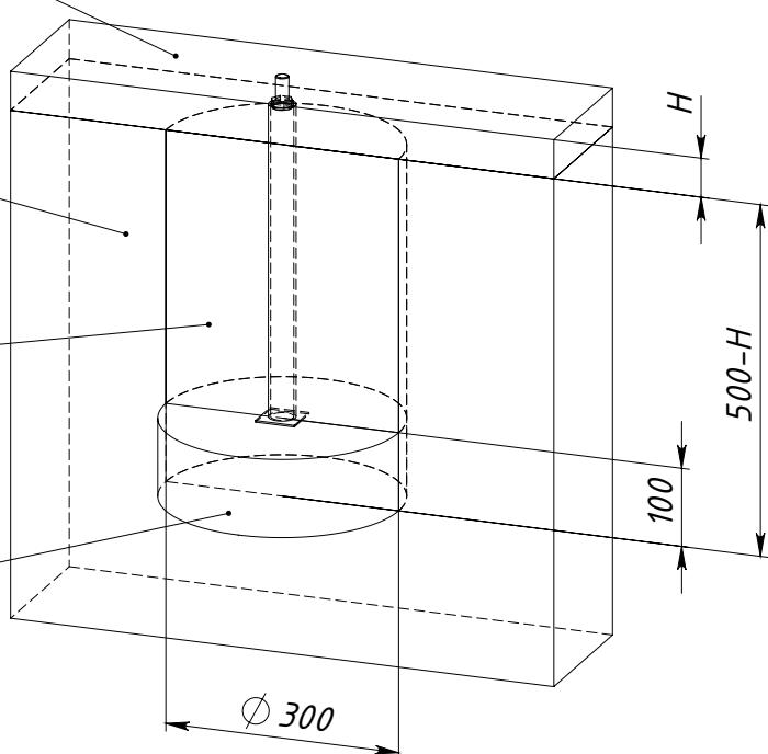
*H — толщина ударопоглощающего покрытия площадки*
