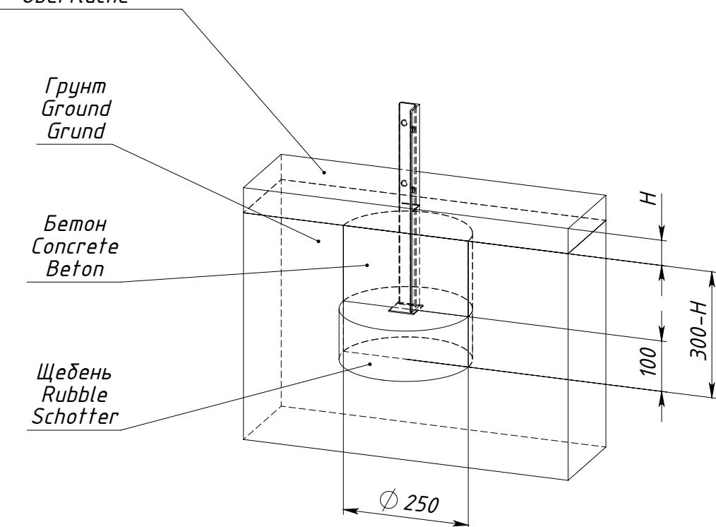
$H$  — толщина ударопоглощающего покрытия площадки
