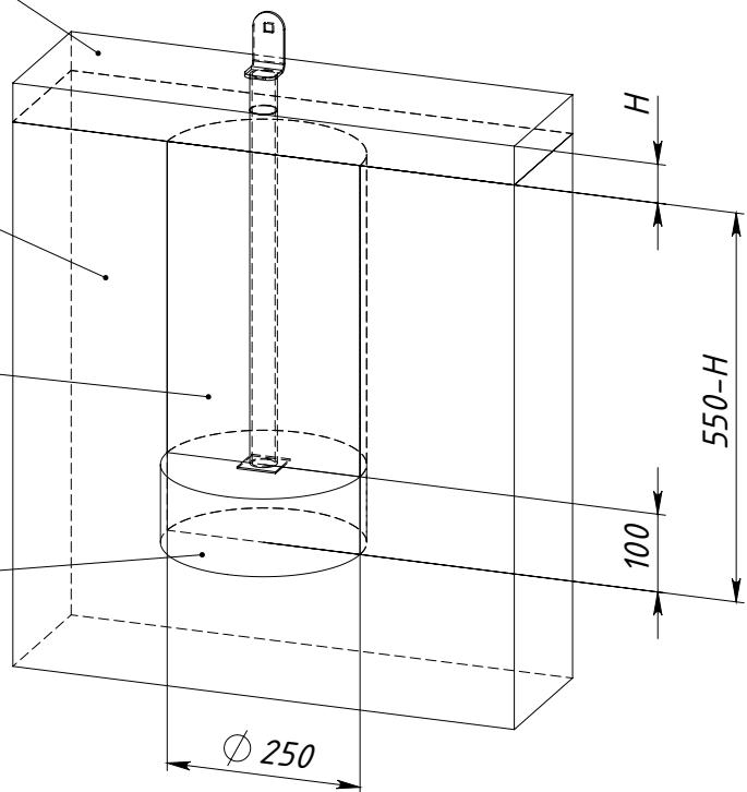
$H$  — толщина ударопоглощающего покрытия площадки
