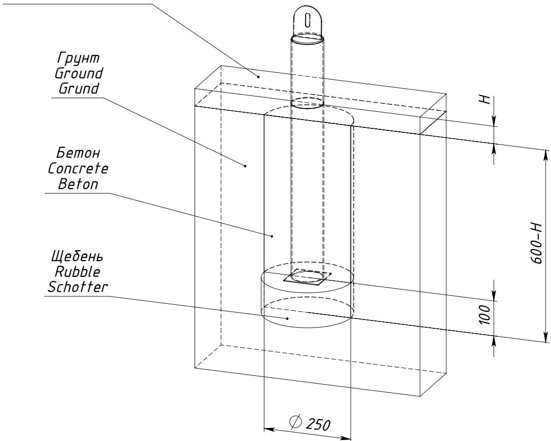
$H$  — толщина ударопоглощающего покрытия площадки
