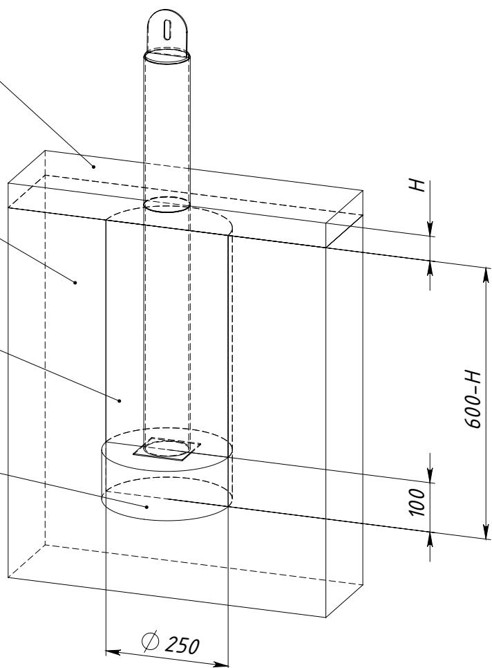
$H$  — толщина ударопоглощающего покрытия площадки
