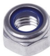
NT10.D985 (Гайка с пластиковой вставкой, M10, DIN 985) — 6 шт
