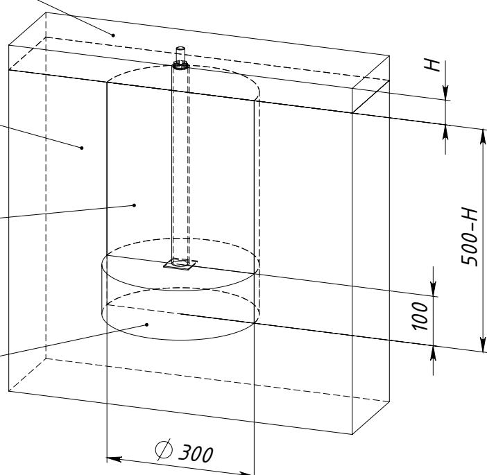
$H$  — толщина ударопоглощающего покрытия площадки
