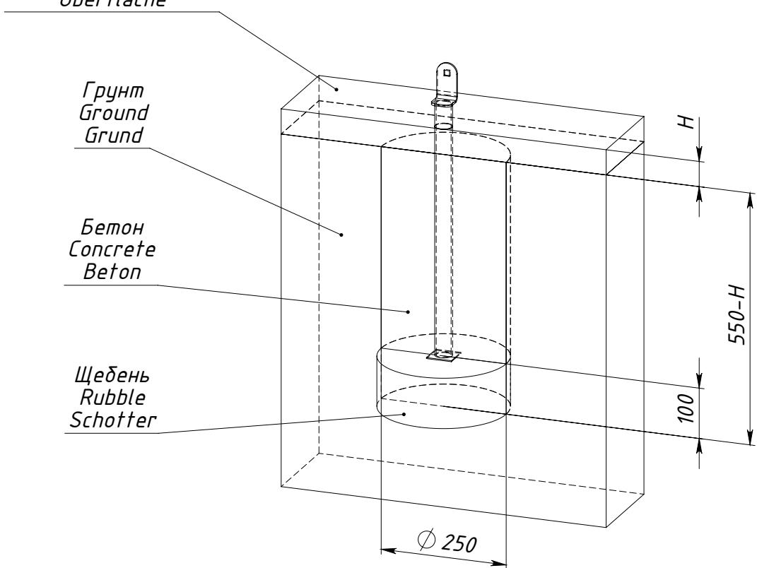
$H$  — толщина ударопоглощающего покрытия площадки
