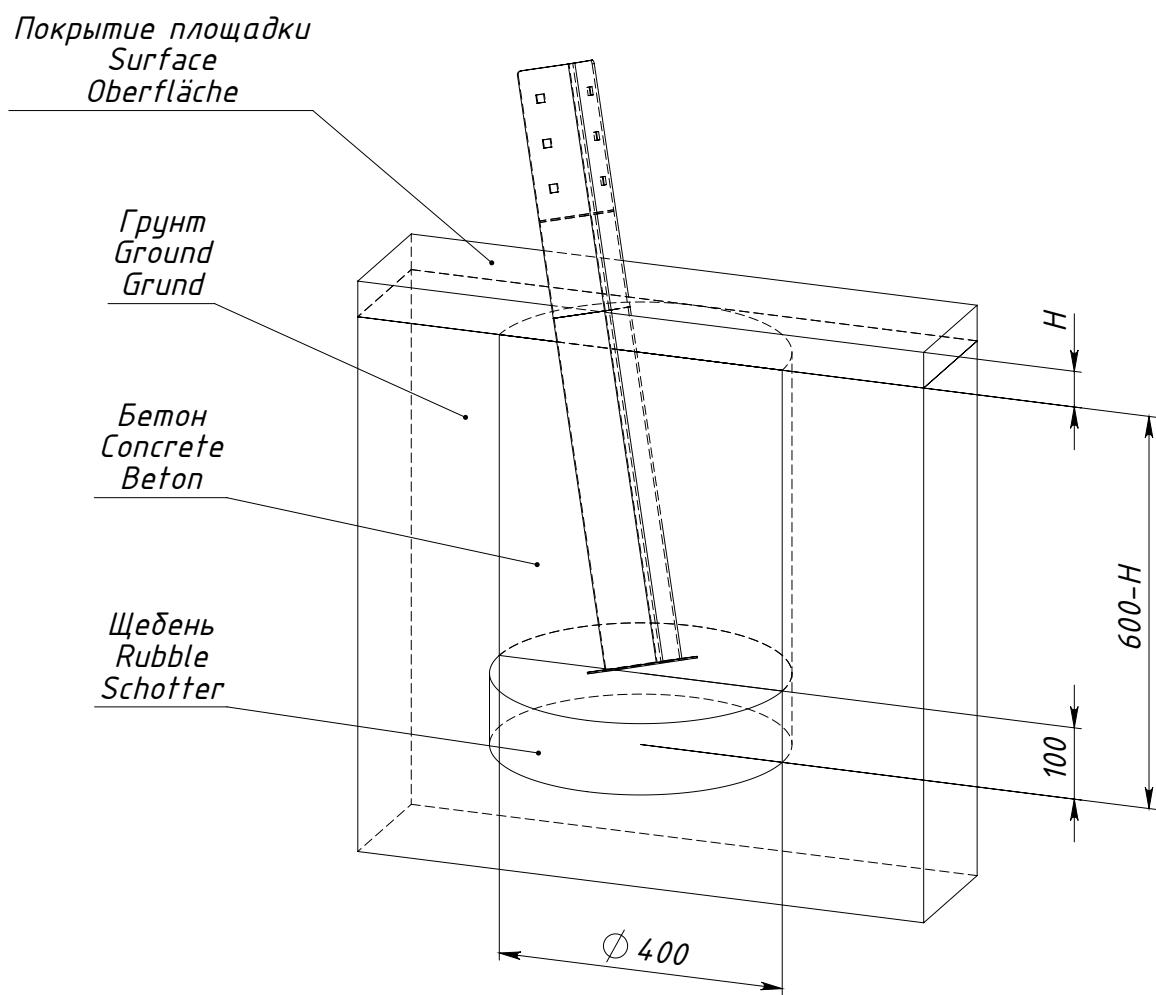
$H$  — толщина ударопоглощающего покрытия площадки
