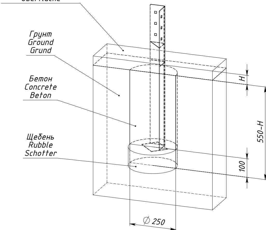
$H$  — толщина ударопоглощающего покрытия площадки
