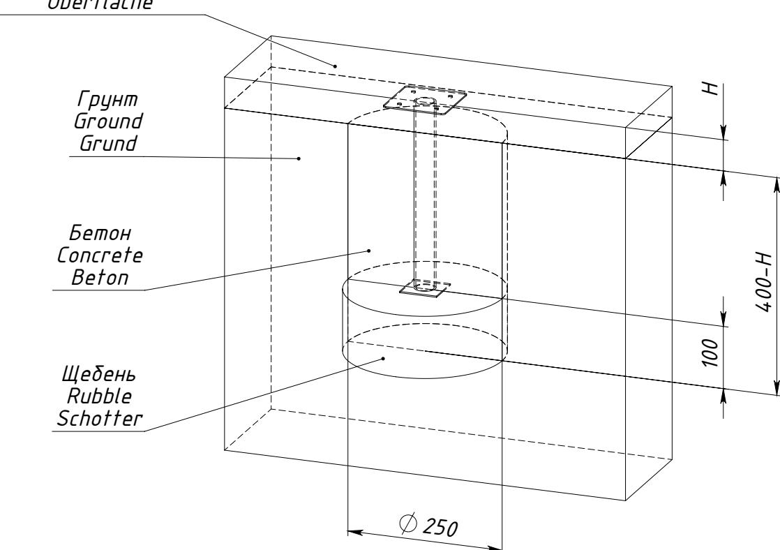
$H$  — толщина ударопоглощающего покрытия площадки
