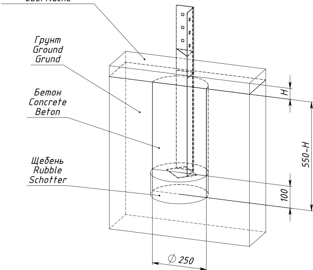
$H$  — толщина ударопоглощающего покрытия площадки
