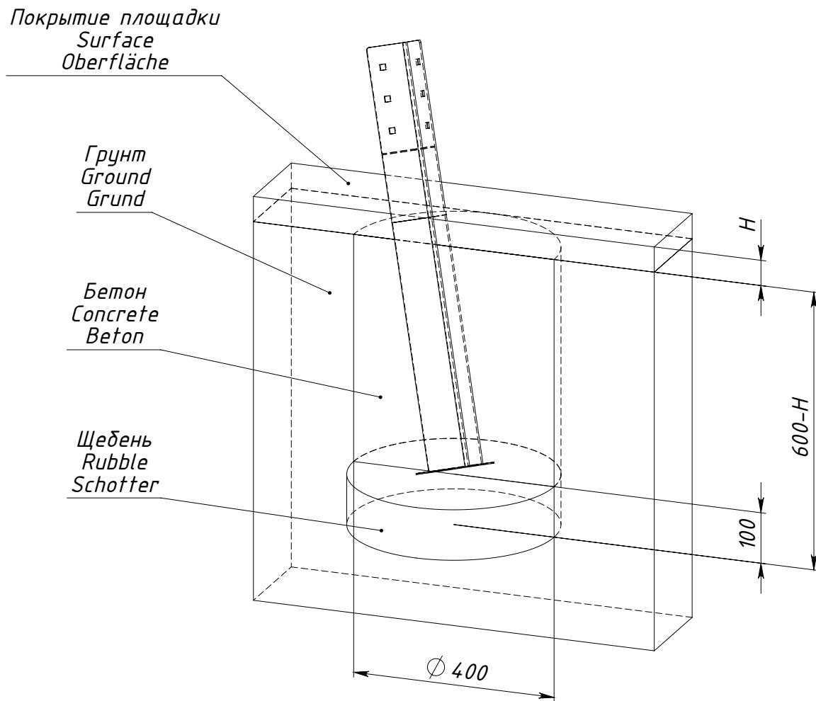
$H$  — толщина ударопоглощающего покрытия площадки
