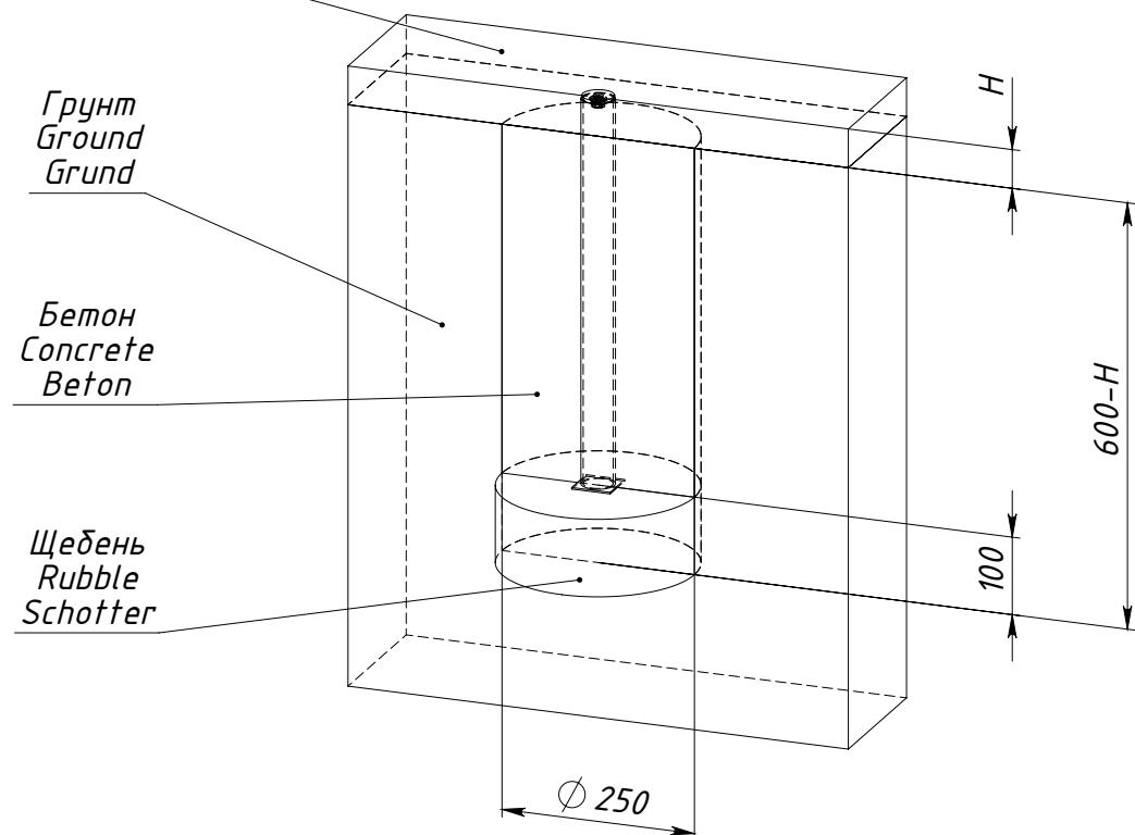
$H$  — толщина ударопоглощающего покрытия площадки
