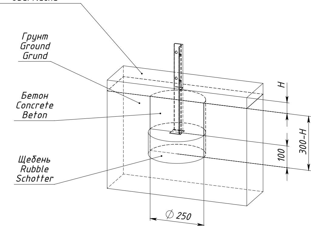
$H$  — толщина ударопоглощающего покрытия площадки
