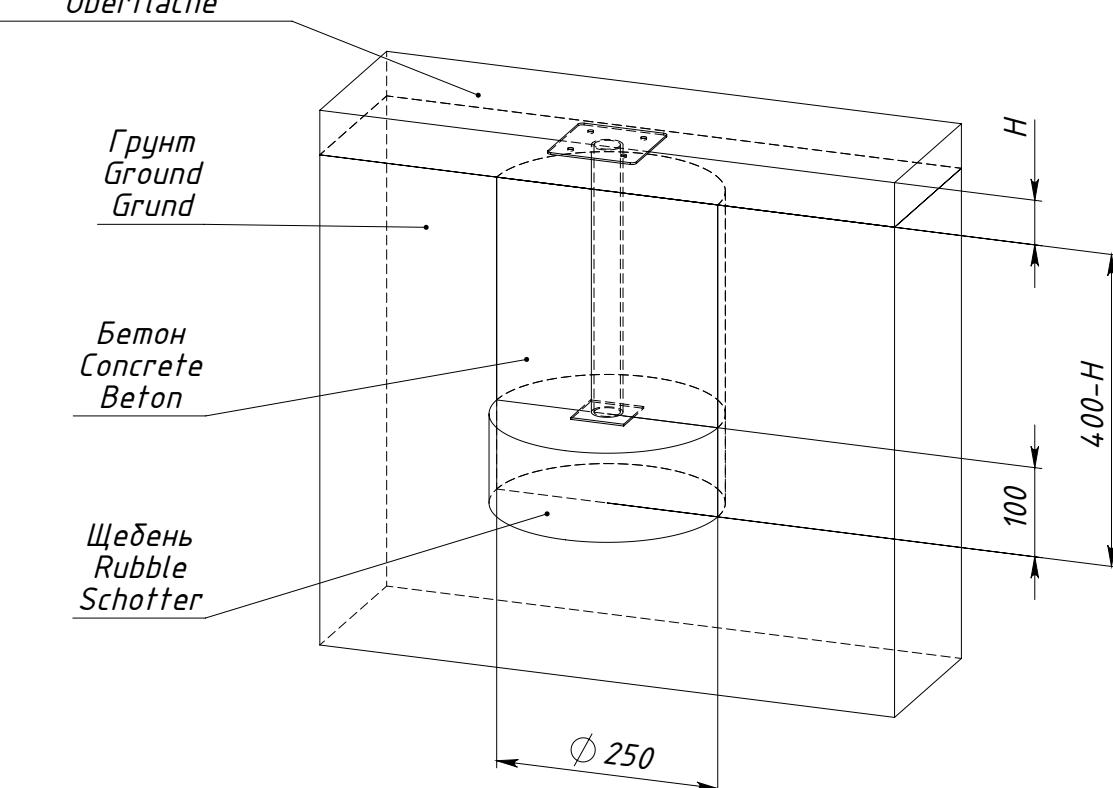
$H$  — толщина ударопоглощающего покрытия площадки
