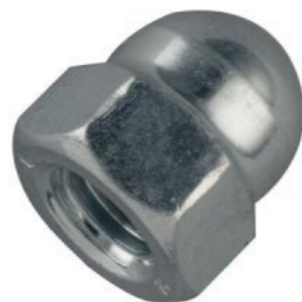
ND10.D1587 (Гайка колпачковая, M10, DIN 1587) — 3 шт
