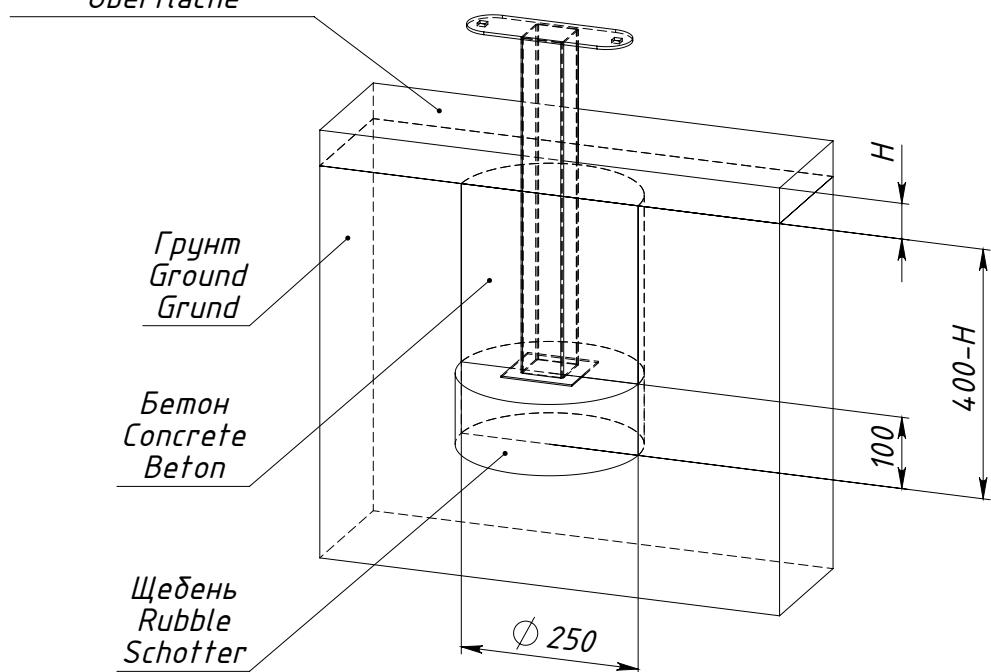
$H$  — толщина ударопоглощающего покрытия площадки
