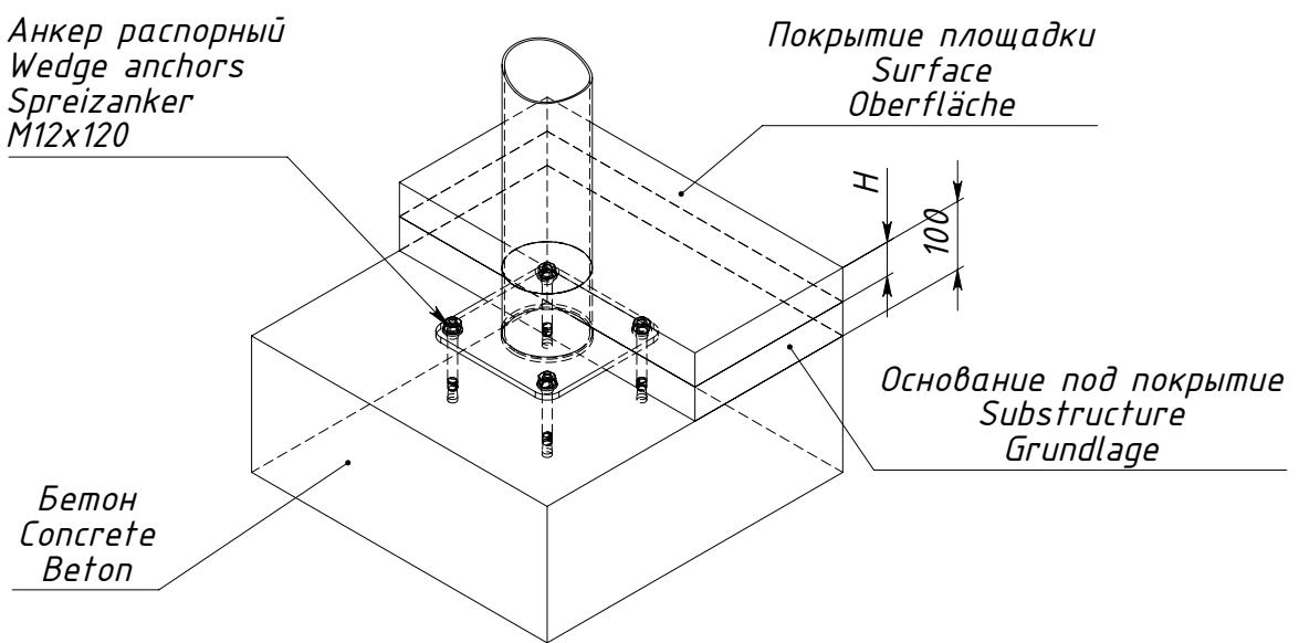
$H$  — толщина ударопоглощающего покрытия площадки
