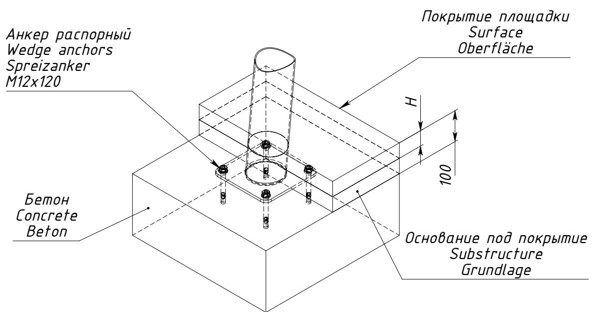
$H$  — толщина ударопоглощающего покрытия площадки
