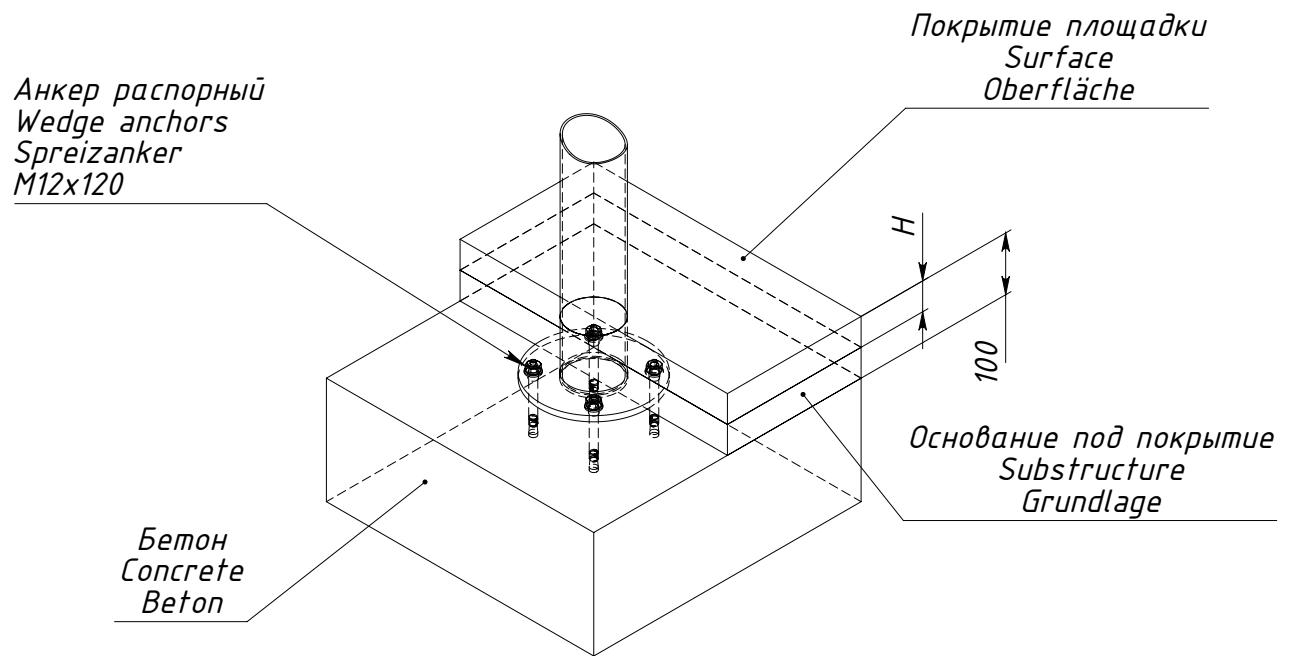
$H$  — толщина ударопоглощающего покрытия площадки
