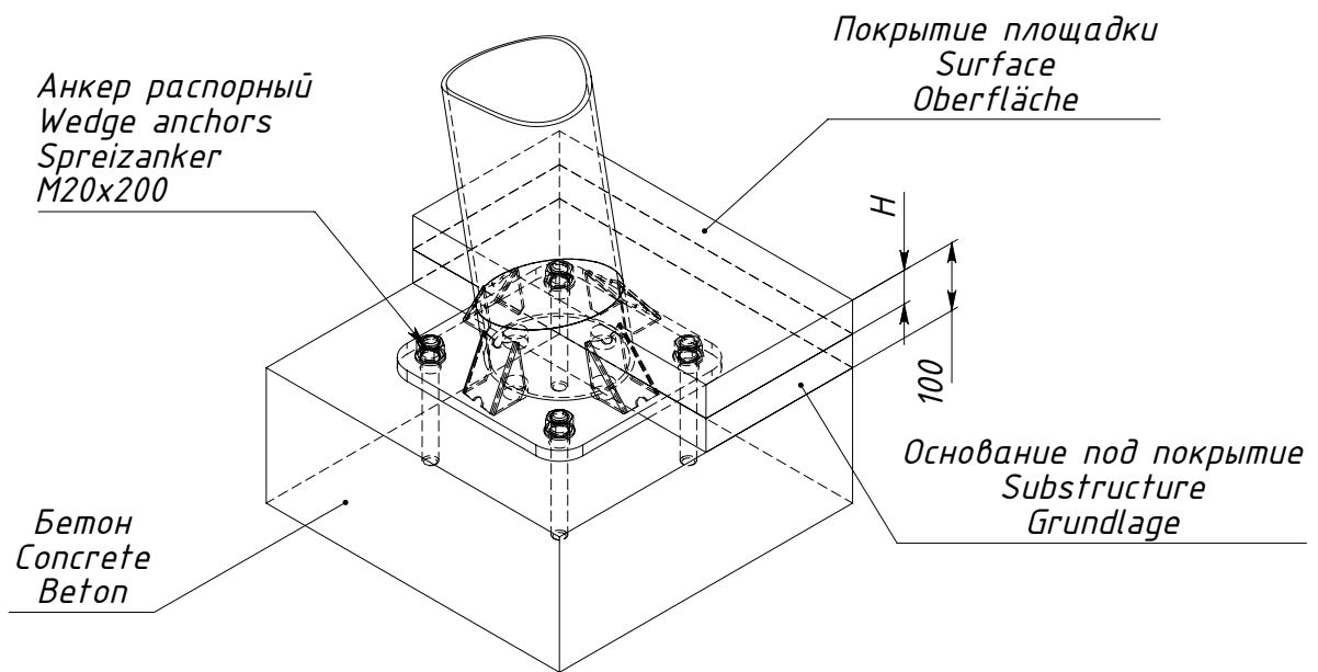
$H$  — толщина ударопоглощающего покрытия площадки
