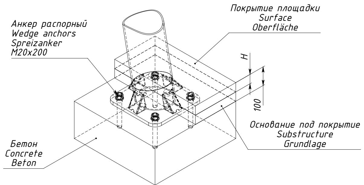
$H$  — толщина ударопоглощающего покрытия площадки
