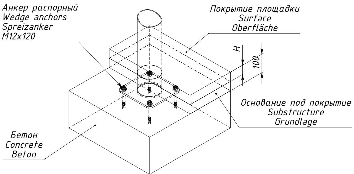
$H$  — толщина ударопоглощающего покрытия площадки
