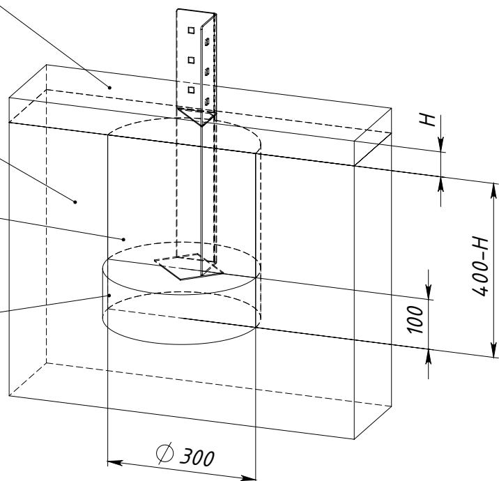
*H — толщина ударопоглощающего покрытия площадки*
