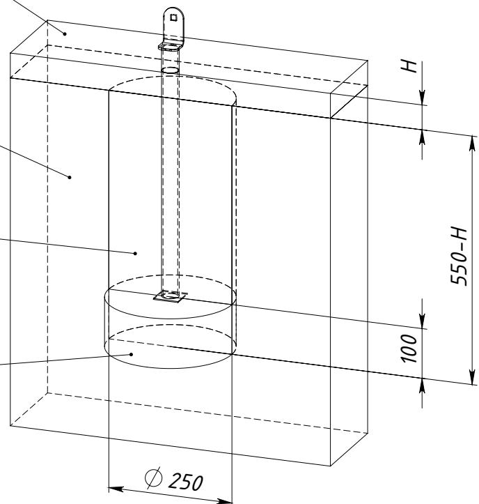
$H$  — толщина ударопоглощающего покрытия площадки
