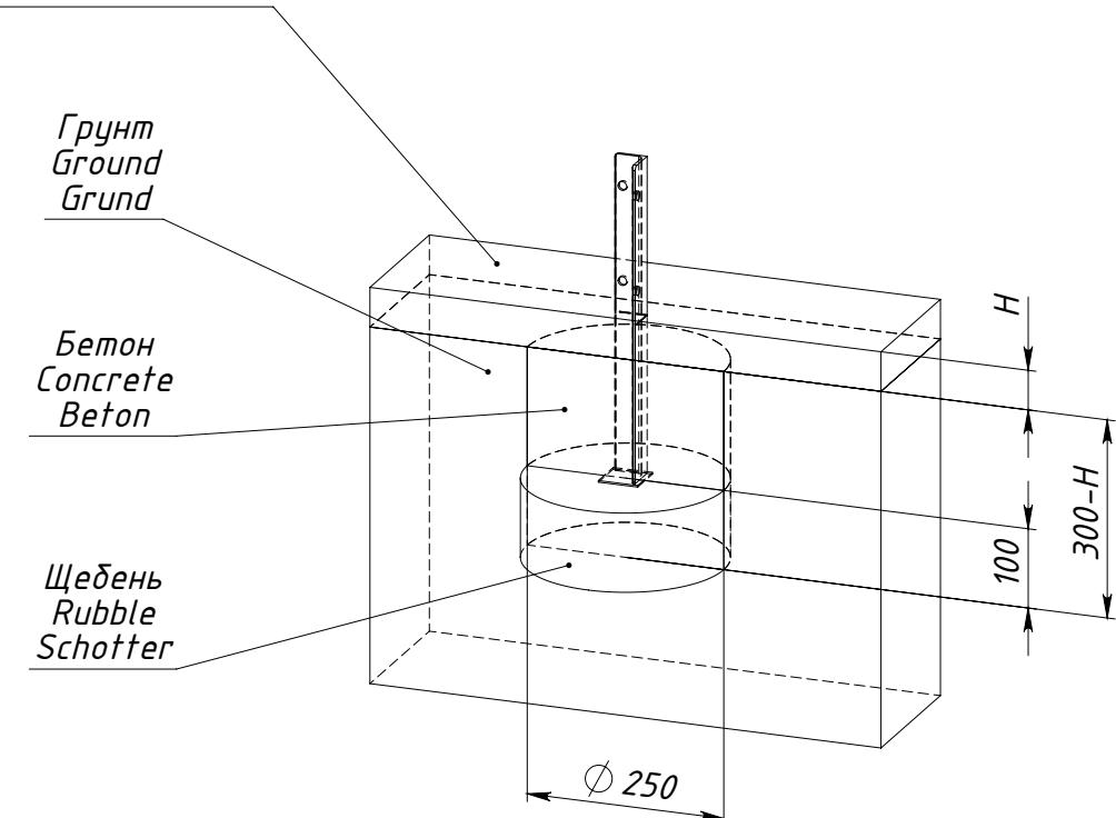
$H$  — толщина ударопоглощающего покрытия площадки
