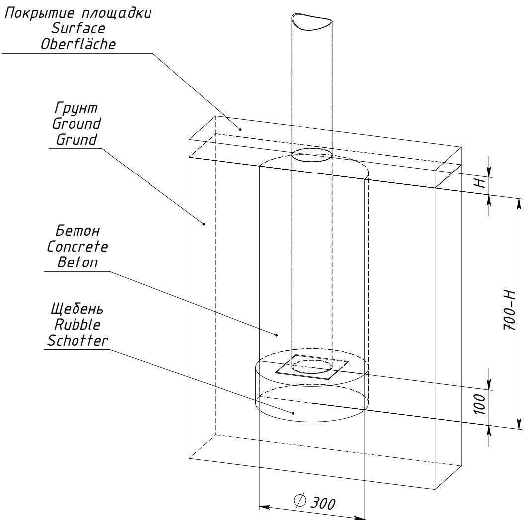
$H$  — толщина ударопоглощающего покрытия площадки
