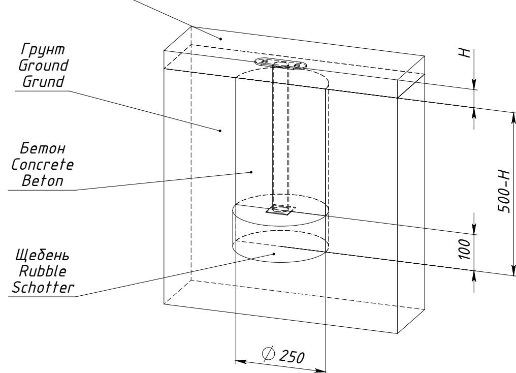
$H$  — толщина ударопоглощающего покрытия площадки
