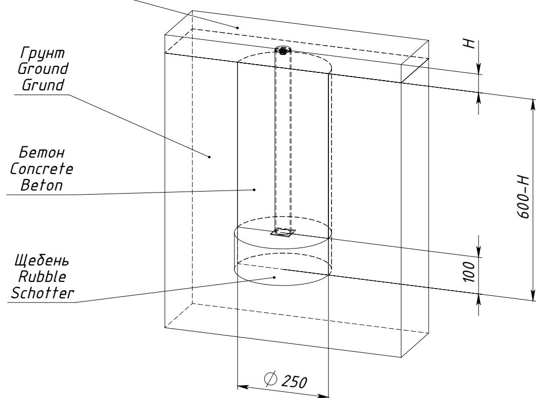
$H$  — толщина ударопоглощающего покрытия площадки
