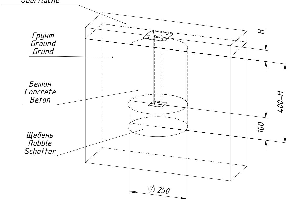
$H$  — толщина ударопоглощающего покрытия площадки
