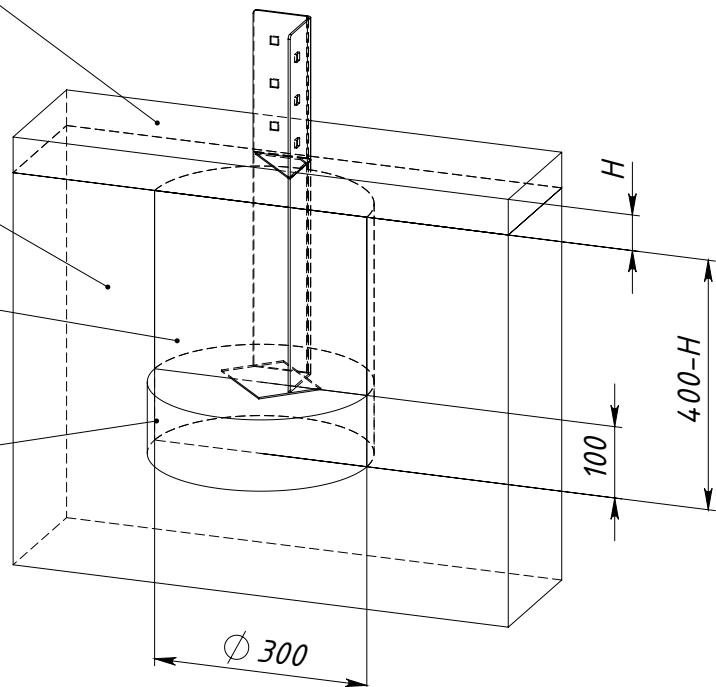
$H$  — толщина ударопоглощающего покрытия площадки
