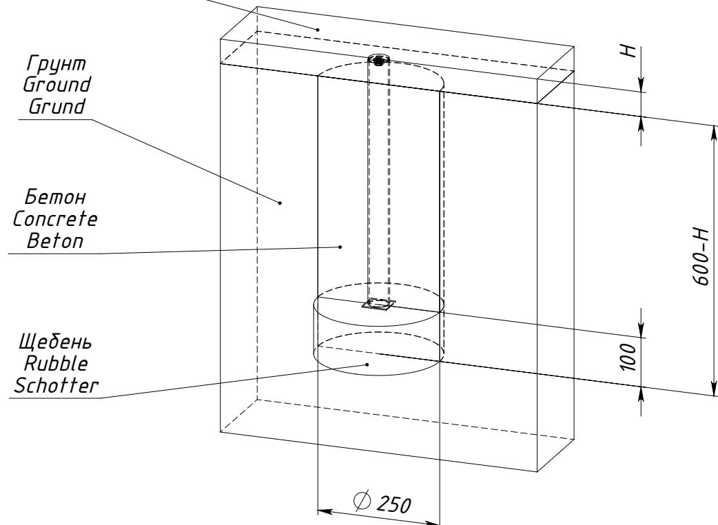
$H$  — толщина ударопоглощающего покрытия площадки
