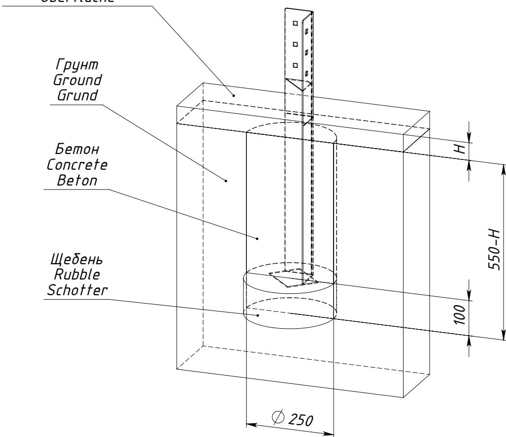
$H$  — толщина ударопоглощающего покрытия площадки
