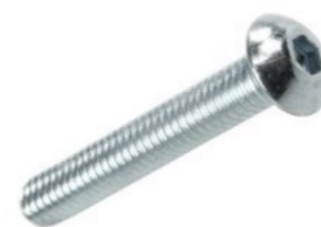
BO10.070.A2.D7380 (Болт полусфер., с внутр. шестигр., нерж., M10×70, DIN 7380) — 2 шт
