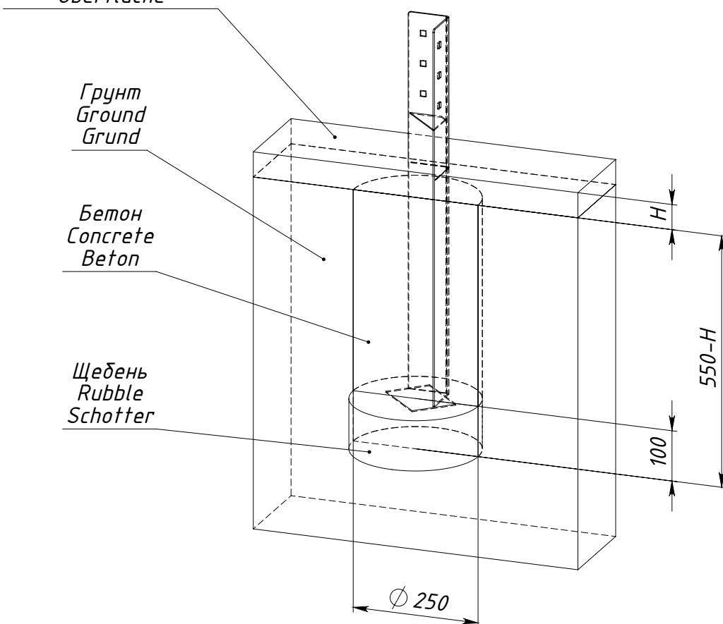
$H$  — толщина ударопоглощающего покрытия площадки
