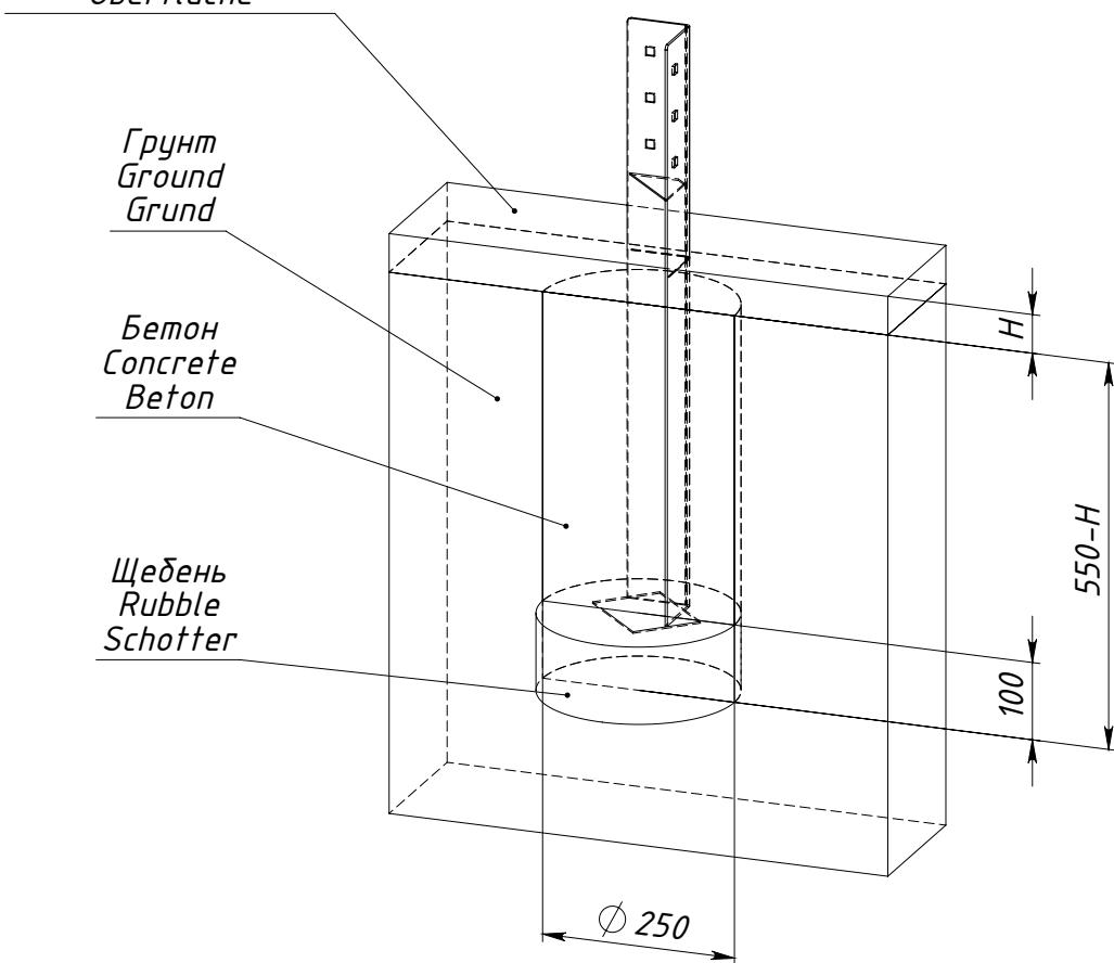
$H$  — толщина ударопоглощающего покрытия площадки
