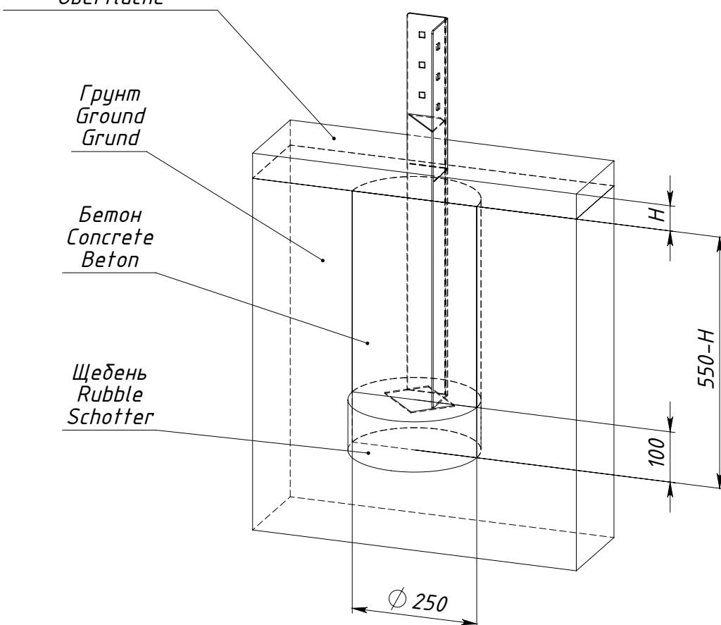
$H$  — толщина ударопоглощающего покрытия площадки
