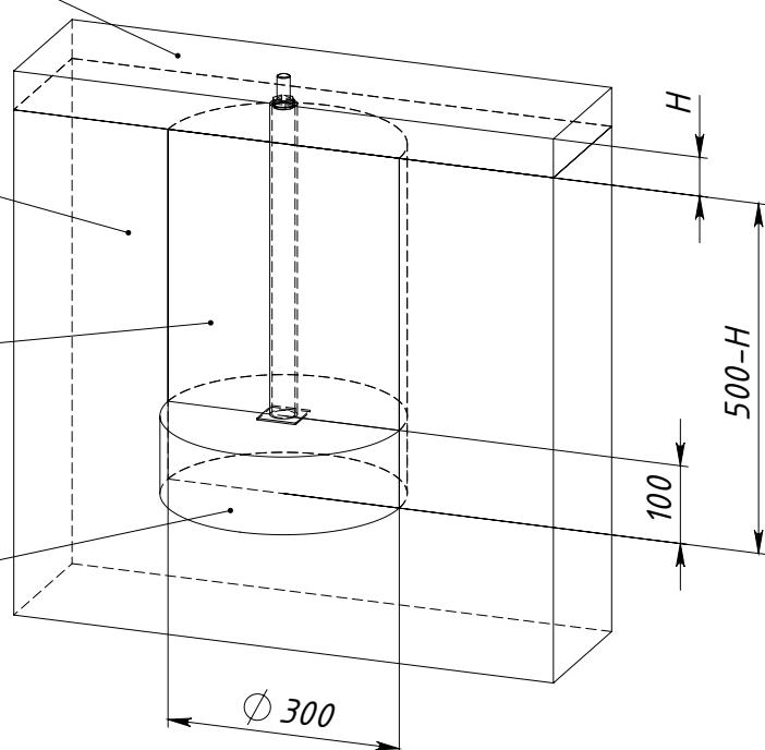
$H$  — толщина ударопоглощающего покрытия площадки
