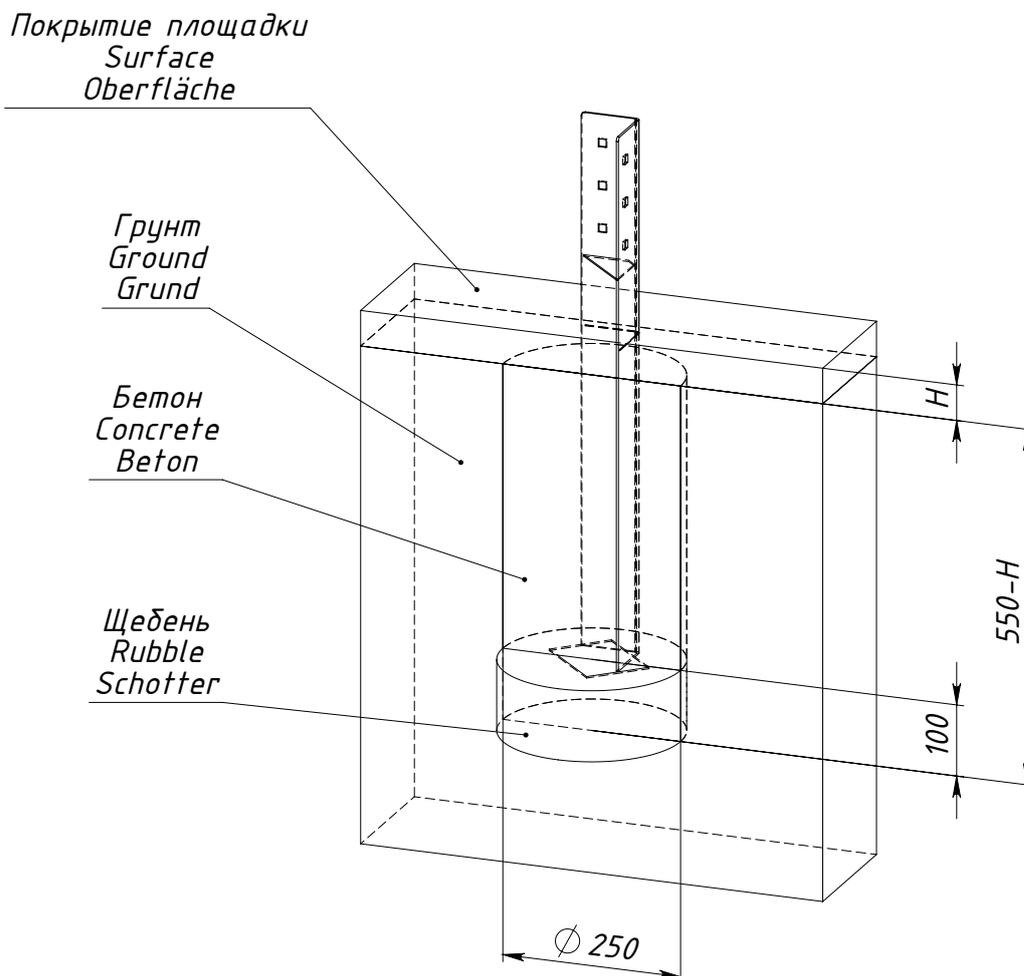
H — толщина ударопоглощающего покрытия площадки
