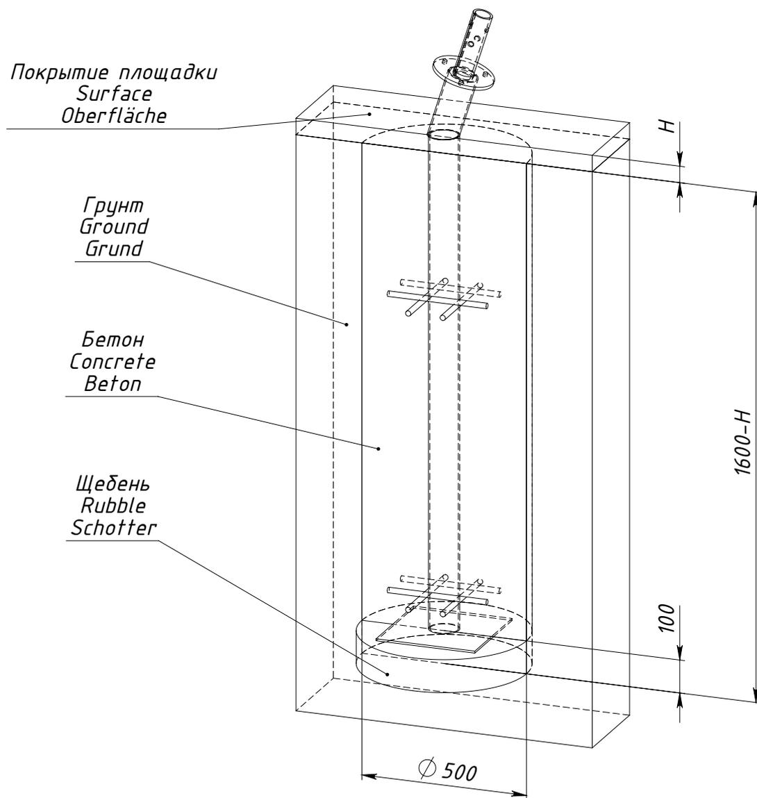
$H$  — толщина ударопоглощающего покрытия площадки
