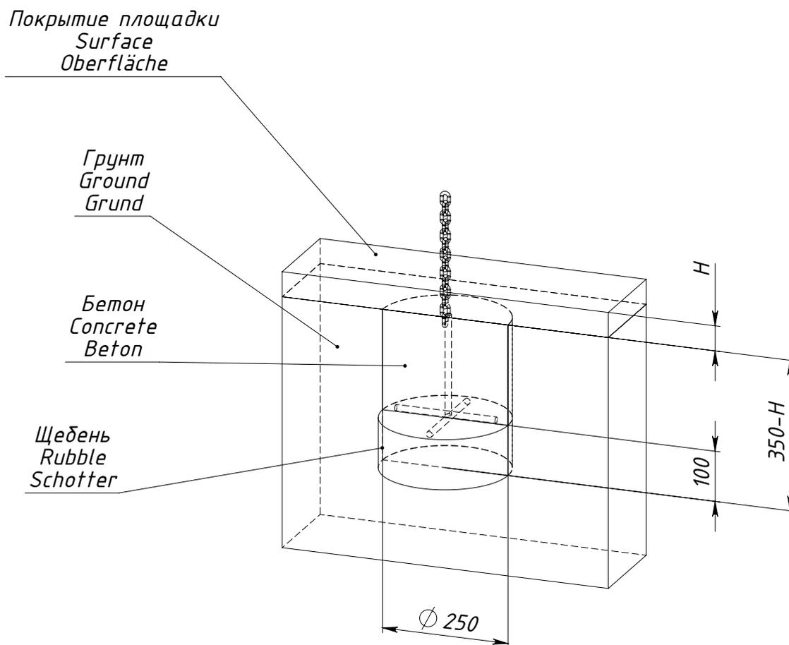
$H$  — толщина ударопоглощающего покрытия площадки
