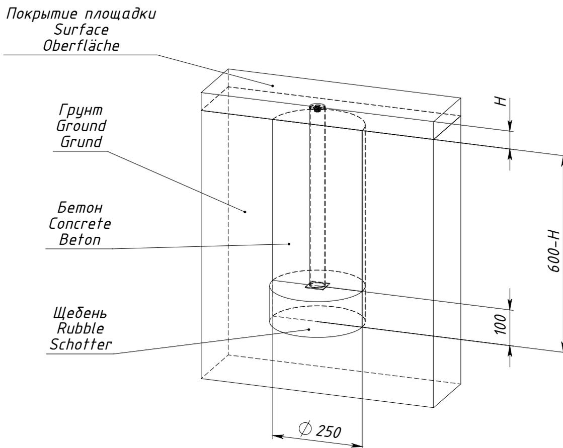
$H$  — толщина ударопоглощающего покрытия площадки
