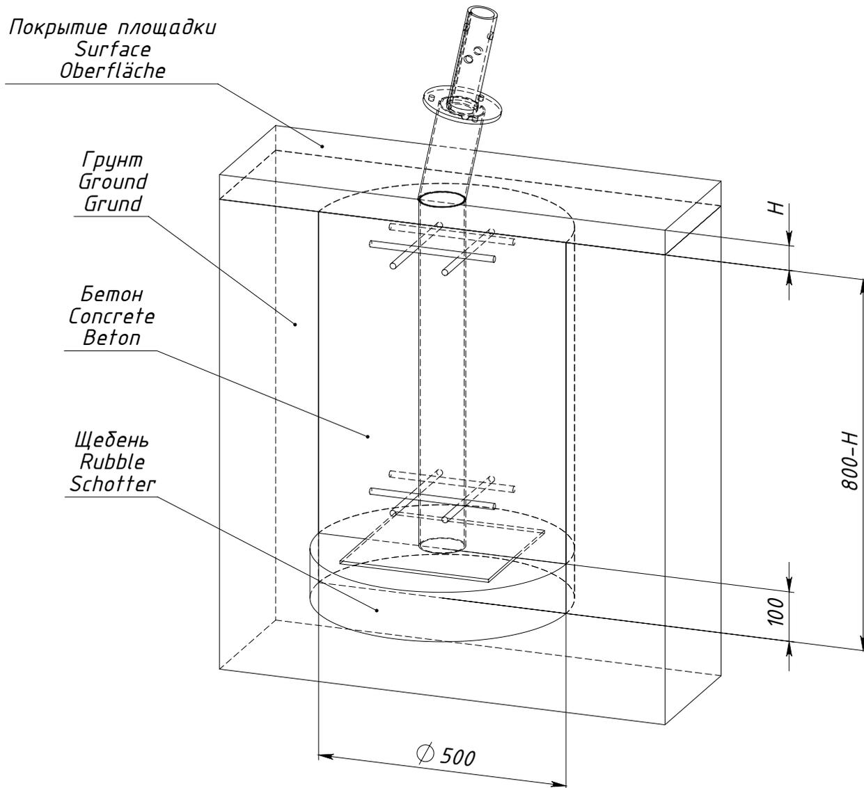
H — толщина ударопоглощающего покрытия площадки
