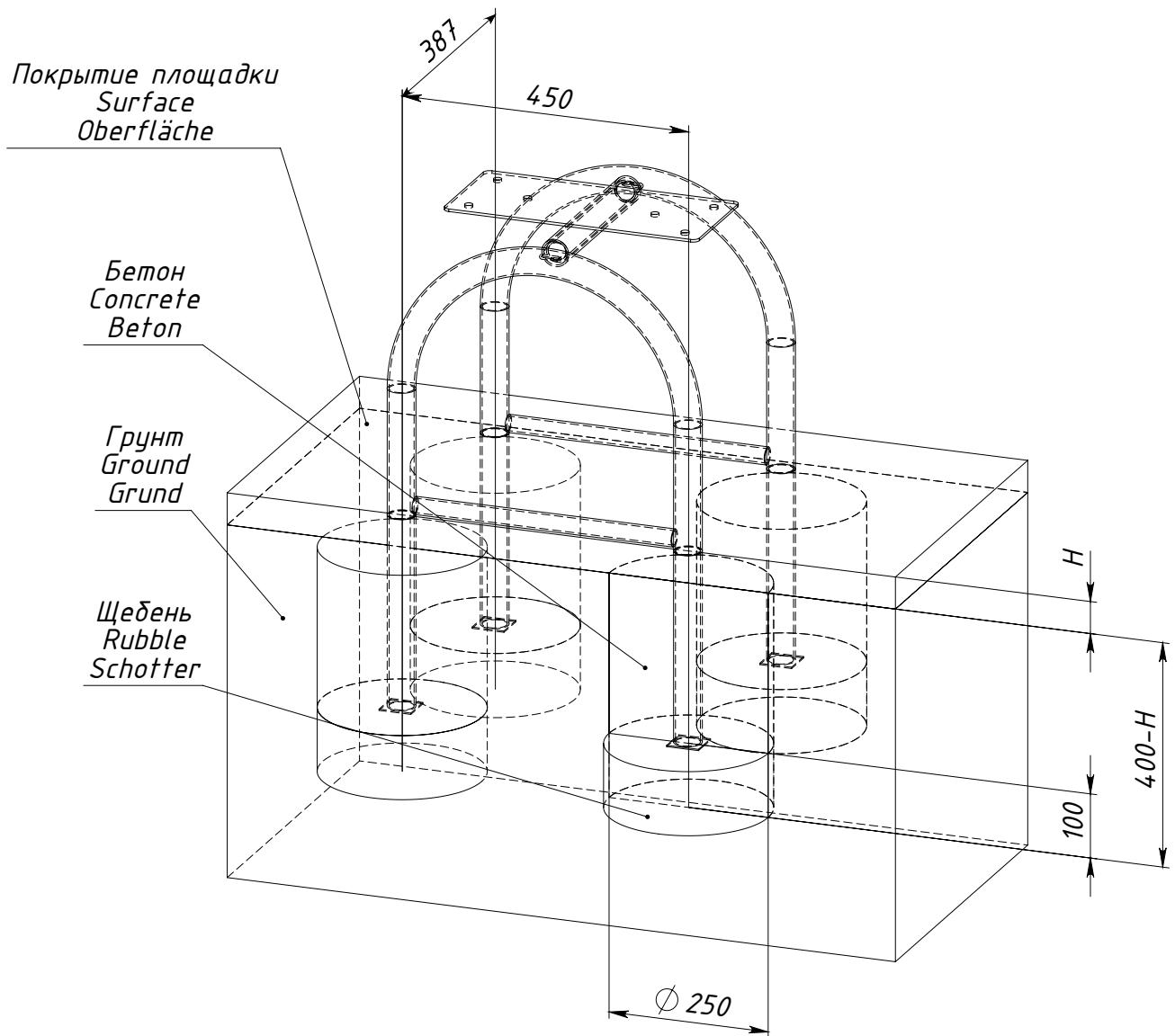
$H$  — толщина ударопоглощающего покрытия площадки
