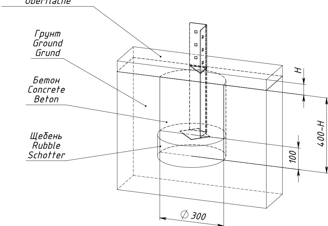
$H$  — толщина ударопоглощающего покрытия площадки
