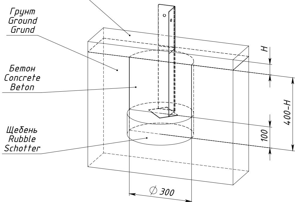
$H$  — толщина ударопоглощающего покрытия площадки
