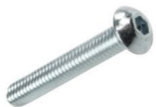
BO08.030.D7380 (Болт полусфер., с внутр. шестигр., M8×30, DIN 7380) — 1 шт
