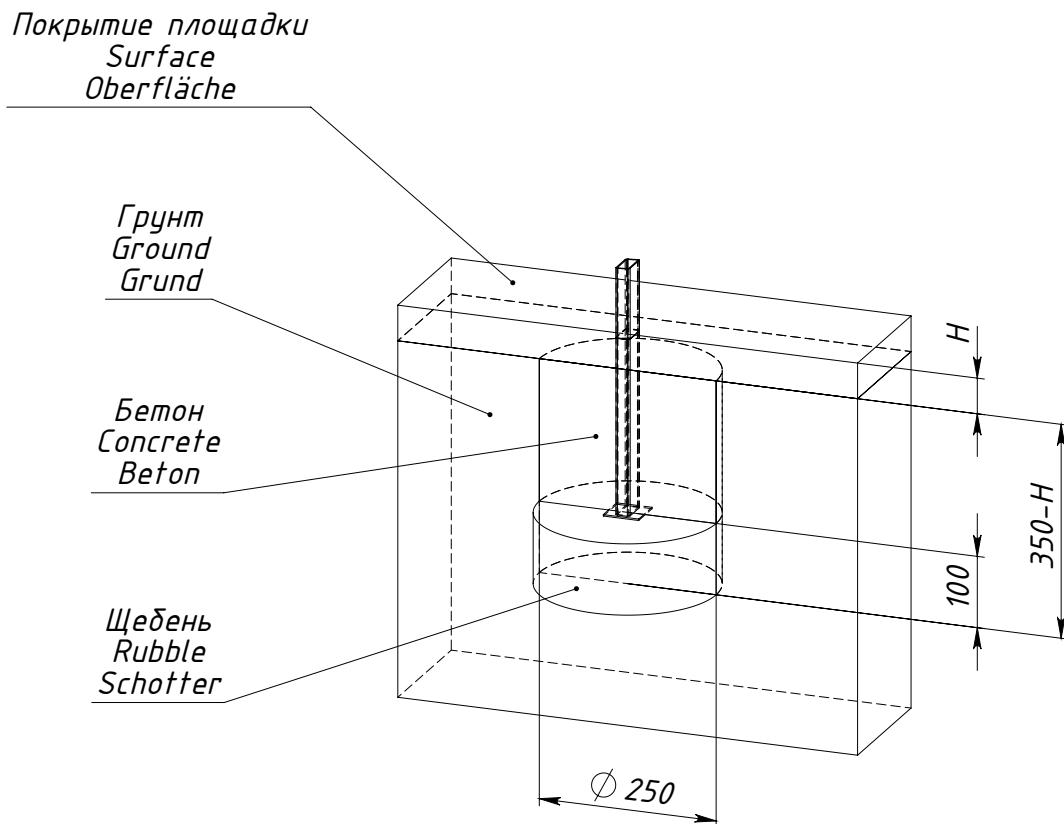
$H$  — толщина ударопоглощающего покрытия площадки
